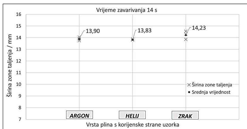
Slika 5.10 Širine zone taljenja i pripadne srednje vrijednosti
