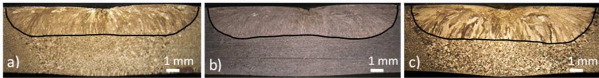
Slika 5.70 Zona taljenja za uzorke s površinom a) u izvornom stanju, b) s brušenom gornjom stranom i c) s brušenom gornjom i donjom stranom; vrijeme zavarivanja 14 s
