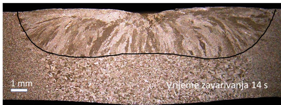
Slika 5.9 Uobičajen oblik zone taljenja za vrijeme zavarivanja od 14 s
