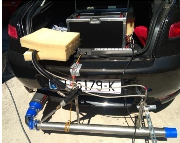
Slika 32. Oprema za mjerenje emisija postavljena na vozilo.
