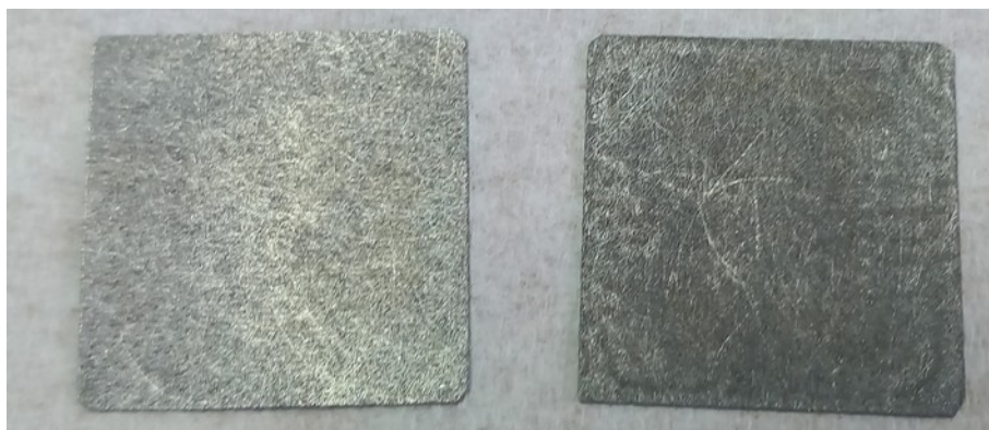
Slika 5.4. Mikroporozni slojevi korišteni na katodi (lijevo) i anodi (lijevo) nakon provedenog čišćenja
