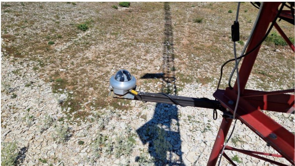
Slika 6-4 Piranometar Delta-T Sunshine montiran na mjernom stupu
