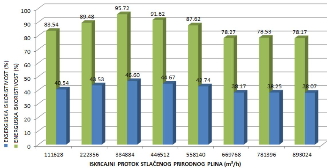
Slika 22. Energijska i eksjergijska iskoristivost generatora pare tijekom procesa uplinjavanja kada se električna energija proizvodi pomoću gorivnih članaka s krutim oksidom bez korištenja toplinske energije nastale radom gorivnih članaka s krutim oksidom
