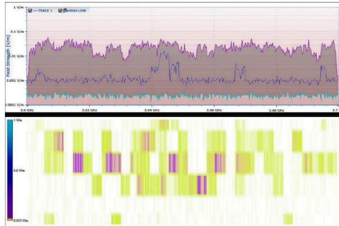
Slika 5.12 Uskopojasno (kanalno) mjerenje s centralnom frekvencijom od 3,75 GHz i širinom aktivnog kanala od 100 MHz
