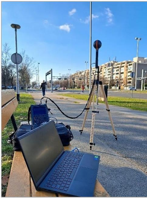
Slika 8.22 Korištena mjerna oprema (analizatora frekvenčijskog spektra, izotropna prijamna antena, nevodljivi tronožac, prijenosno računalo te koaksijalni i LAN kabel)
