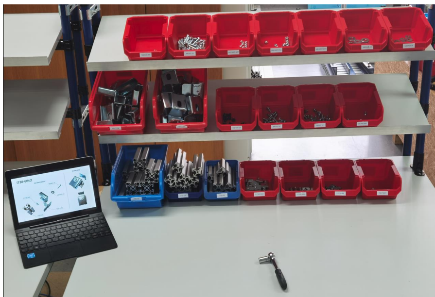
Slika 4.14. Primjer radne stanice za montažu sedam proizvoda s maksimalnim brojem raznolikih ugradbenih dijelova
