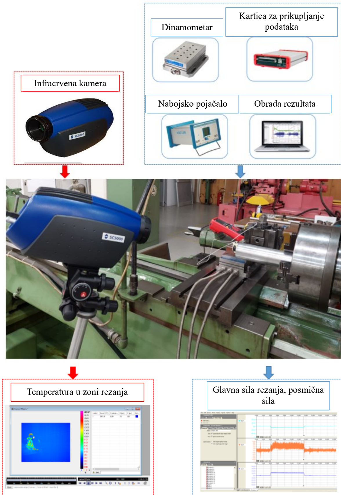
Slika 5.6. Eksperimentalni postav za mjerenje komponenti sile rezanja i temperature u zoni rezanja
