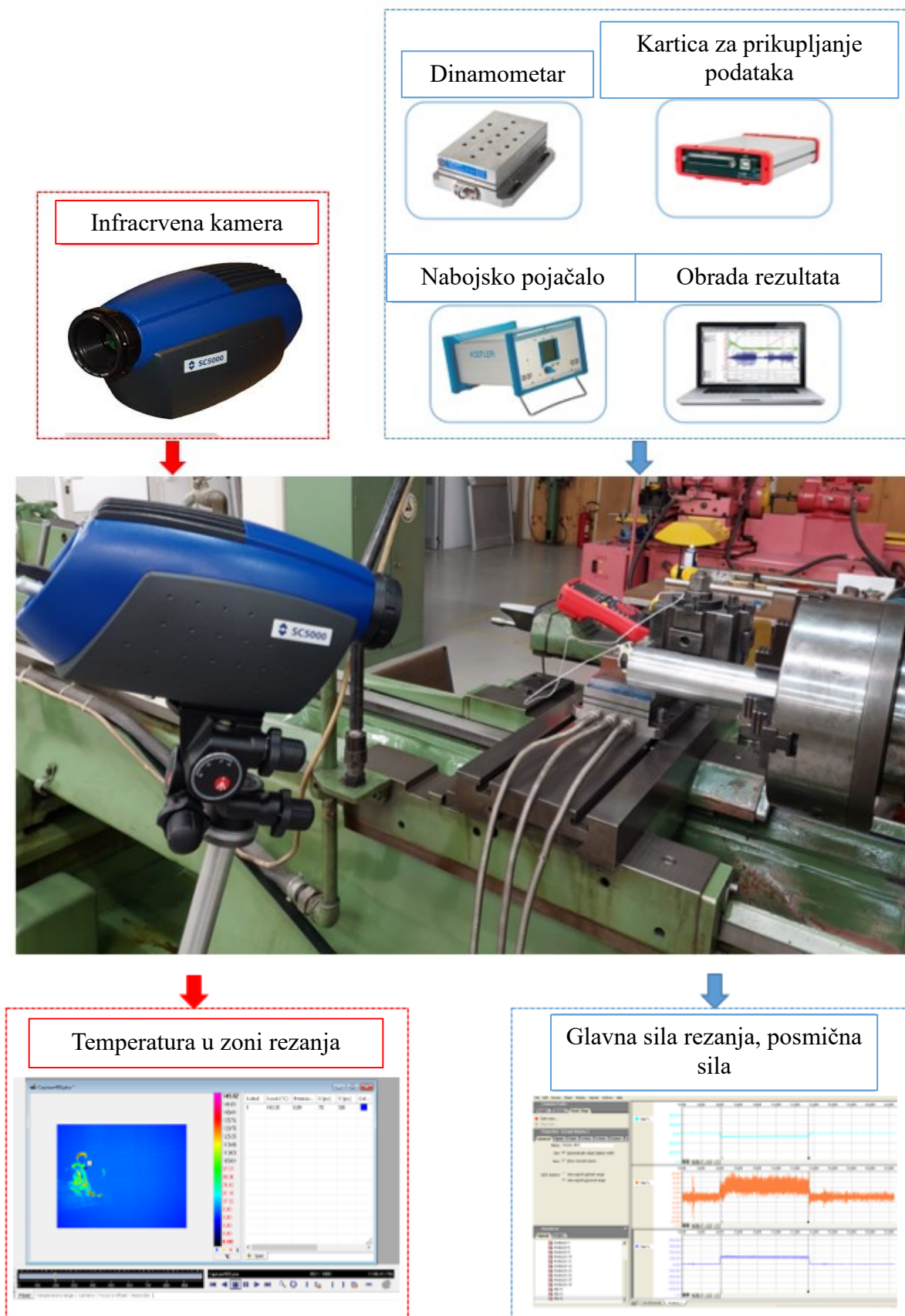
Slika 5.6. Eksperimentalni postav za mjerene komponenti sile rezanja i temperature u zoni rezanja
