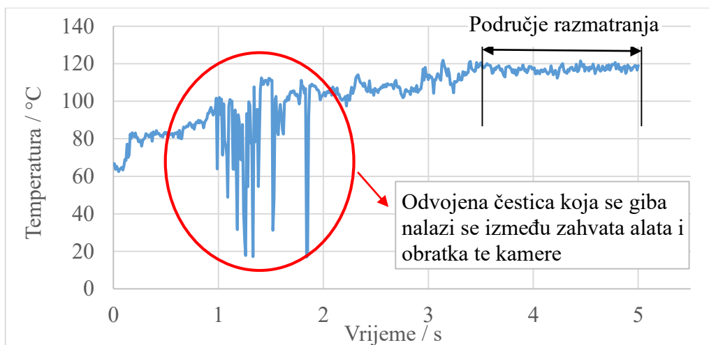
Slika 5.10. Izmjerena temperatura u zoni rezanja za v_c = 93 \text{ m/min} , f = 0,05 \text{ mm/o}
