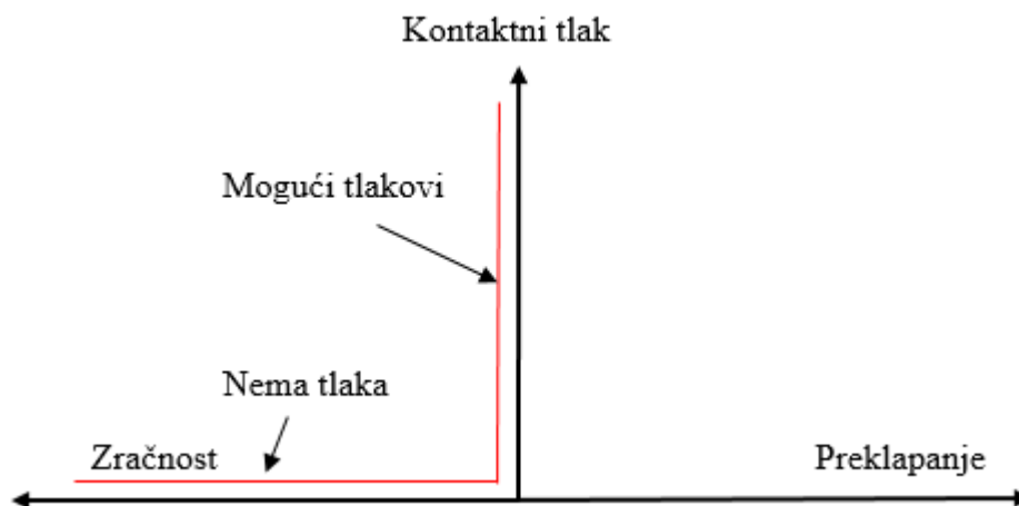
Slika 3.2. Dijagram kontaktnog tlaka i udaljenost površina u dodiru
