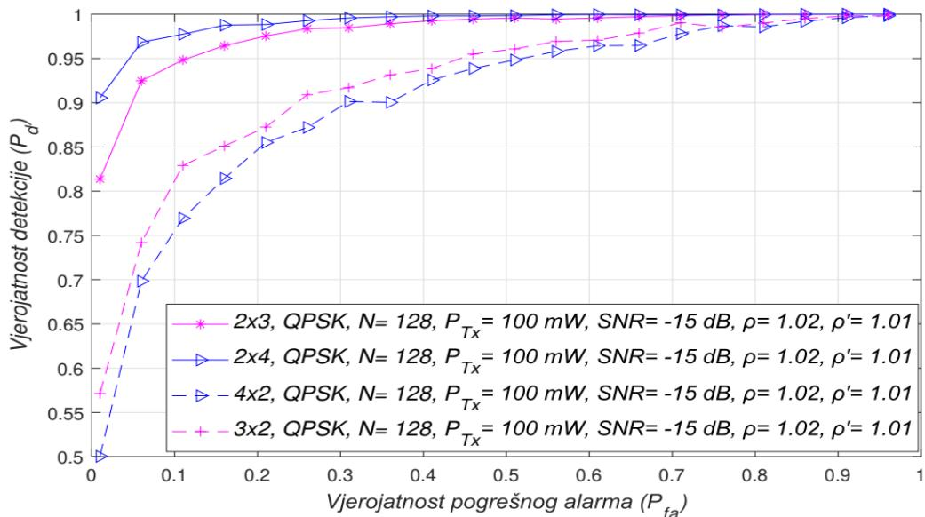
Slika 7.4. Krivulje radnih karakteristika prijemnika (ROC krivulje) za metodu detekcije energije (ED) ostvarene za asimetrične  $2 \times 3$ ,  $2 \times 4$ ,  $4 \times 2$  i  $3 \times 2$  MIMO-OFDM komunikacijske sustave
