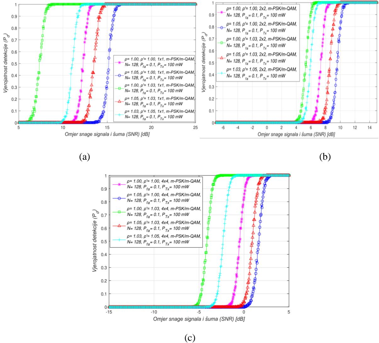
*Slika 7.21. Ovisnost vjerojatnosti detekcije o omjeru snage signala i šuma (SNR) za metodu detekcije energije (ED) izvedenu s različitim kombinacijama faktora dinamičkog praga detekcije (DDT) i nesigurnosti snage šuma (NU) u: (a) SISO, (b) simetričnom 2x2 MIMO i (c) simetričnom 4x4 MIMO komunikacijskom sustavu*
