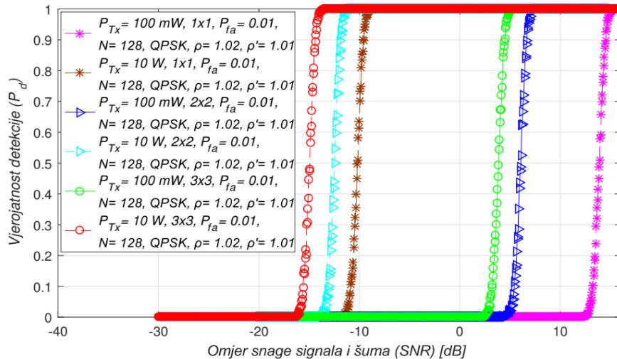
Slika 7.11. Međuvisnost vjerojatnosti detekcije i omjera snage signala i šuma (SNR-a) u procesu detekcije energije (ED) signala koji se prenose s različitim snagama odašiljanja (Tx) primarnog korisnika (PU) u simetričnim MIMO sustavima prijenosa
