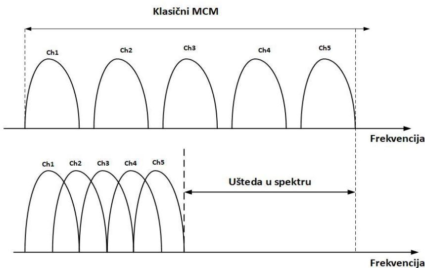
Slika 3.1. Eksploracija frekvencijskog opsega kod klasičnog MCM-a i OFDM-a
