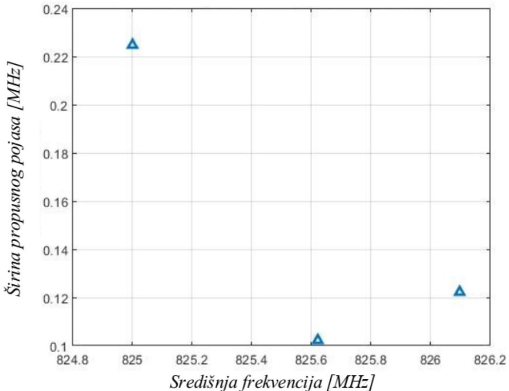
Slika 5.5. Prisutni signali nakon testiranja metode detekcije energije u frekvenčijskom pojasu od 824 MHz – 827 MHz
