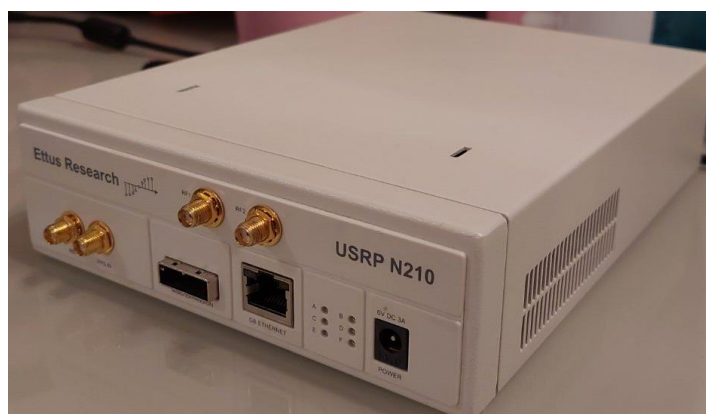
Slika 5.2. Uređaj USRP N210 korišten u eksperimentalnom radu
