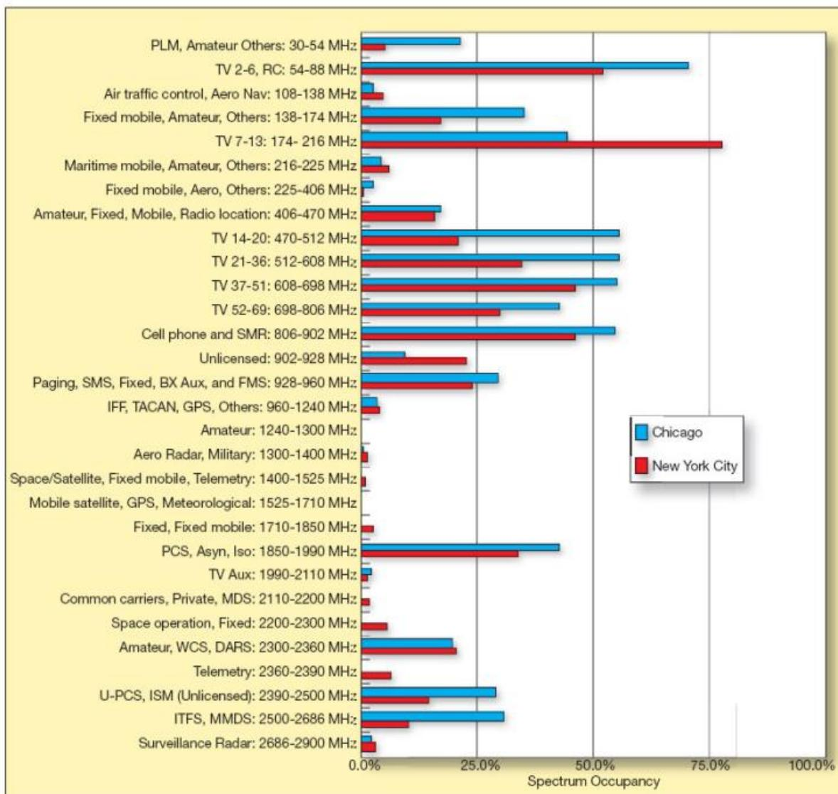
Slika 1.2. Zauzetost frekvencijskog spektra na mjerjenim lokacijama [2]
