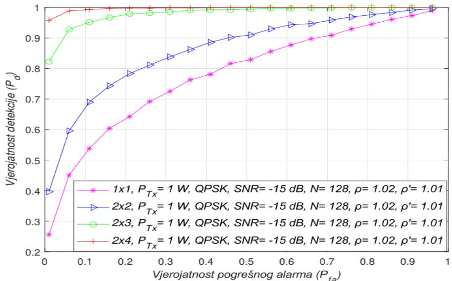
Slika 7.18. Međuvisnost detekcije i vjerojatnosti pogrešnog alarma za SISO, simetrične i asimetrične MIMO-OFDM sustave
