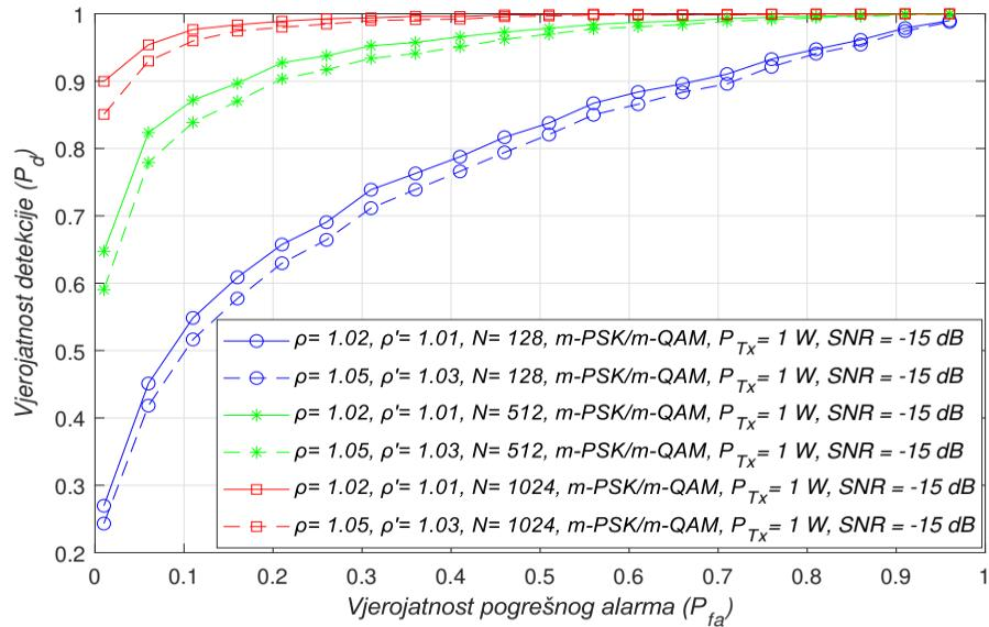
Slika 6.11. Krivulje radnih karakteristika prijemnika (ROC krivulje) procesa detekcije energije (ED) za m-PSK/m-QAM signale odaslane sa snagom odašiljanja (Tx) od 1 W i detektiranih s različitim količinama uzoraka
