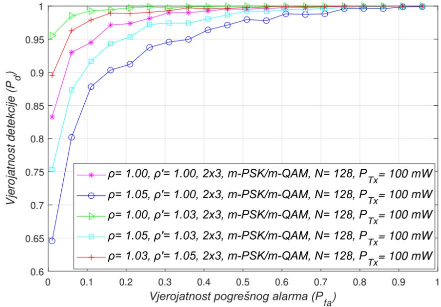
Slika 7.23. Krivulje radnih karakteristika prijemnika (ROC krivulje) za različite kombinacijama faktora dinamičkog praga detekcije (DDT) i nesigurnosti snage šuma (NU) u asimetričnim  $2 \times 3$  MIMO sustavima karakteriziranim prijenosom signala s  $m$ -PSK/ $m$ -QAM modulacijom,  $N = 128$ ,  $SNR = -15$  dB i  $P_{tx} = 100$  mW
