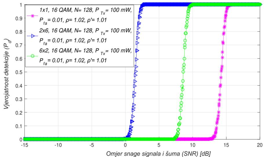
Slika 7.15. Međuvisnost vjerojatnosti detekcije i omjera snage signala i šuma (SNR) za SISO, 2x6 i 6x2 asimetrični MIMO prijenosni sustav
