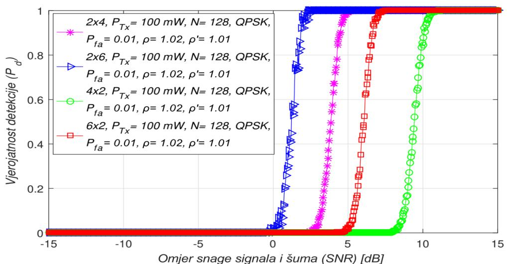
Slika 7.16. Međuvisnost vjerovatnosti detekcije i omjera snage signala i šuma (SNR-a) za različite kombinacije asimetričnih odašiljačkih (Tx) i prijemnih (Rx) grana MIMO prijenosnih sustava
