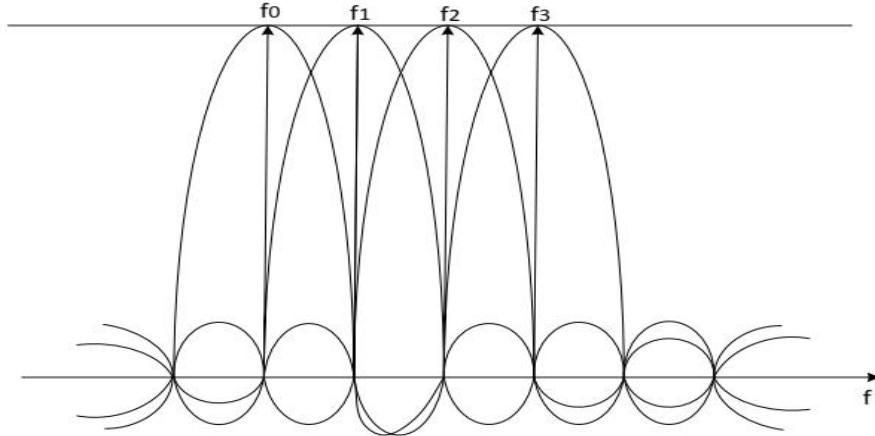
Slika 3.4. Realizacija ortogonalnosti podnositaca OFDM sustava
