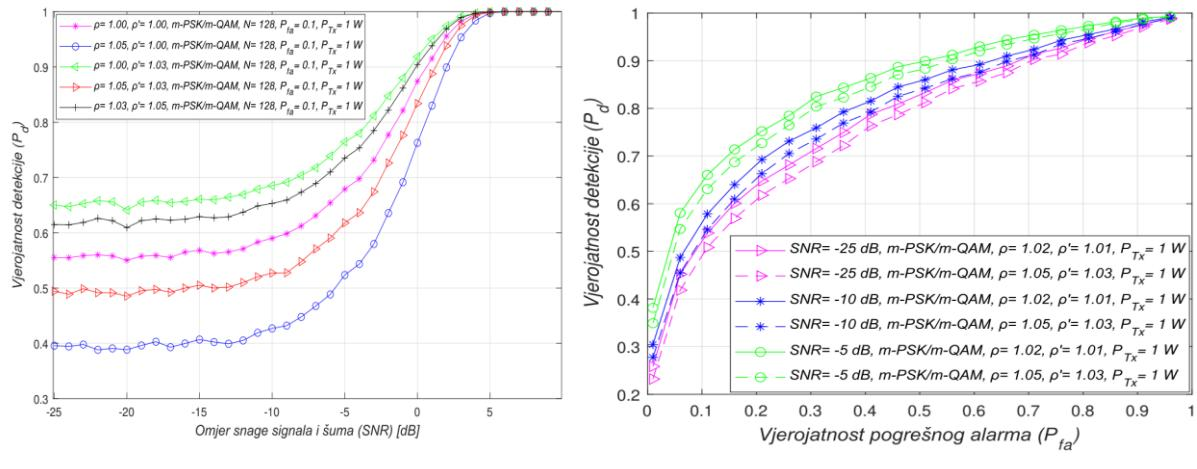
Slika 6.7. (a) Međuovisnost vjerojatnosti detekcije i omjera snage signala i šuma (SNR-a) za signale koji se prenose u RA sustavima; (b) Krivulje radnih karakteristika prijemnika (ROC krivulje) za različite vrijednosti faktora nesigurnosti snage šuma (NU), dinamičkog praga detekcije (DDT) i omjera snage signala i šuma (SNR) u slučaju RA sustava
