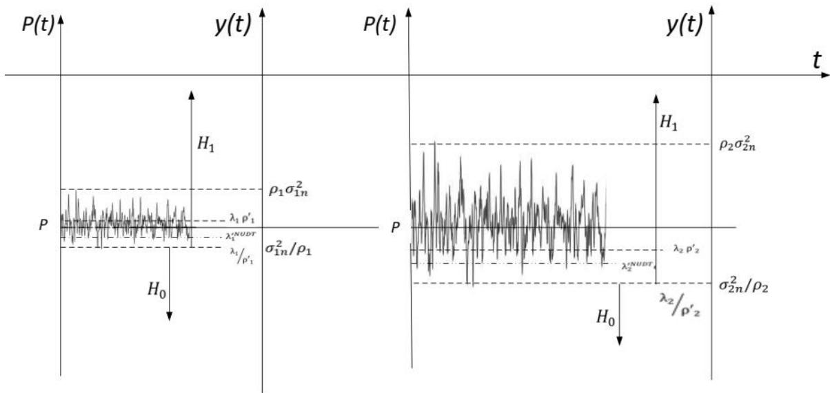
Slika 4.1. Ilustrativni prikaz raspona dinamičkog praga detekcije (DDT) i nesigurnosti snage šuma (NU) u procesu detekcije (ED) za signale jednake prosječne snage odašiljanja
