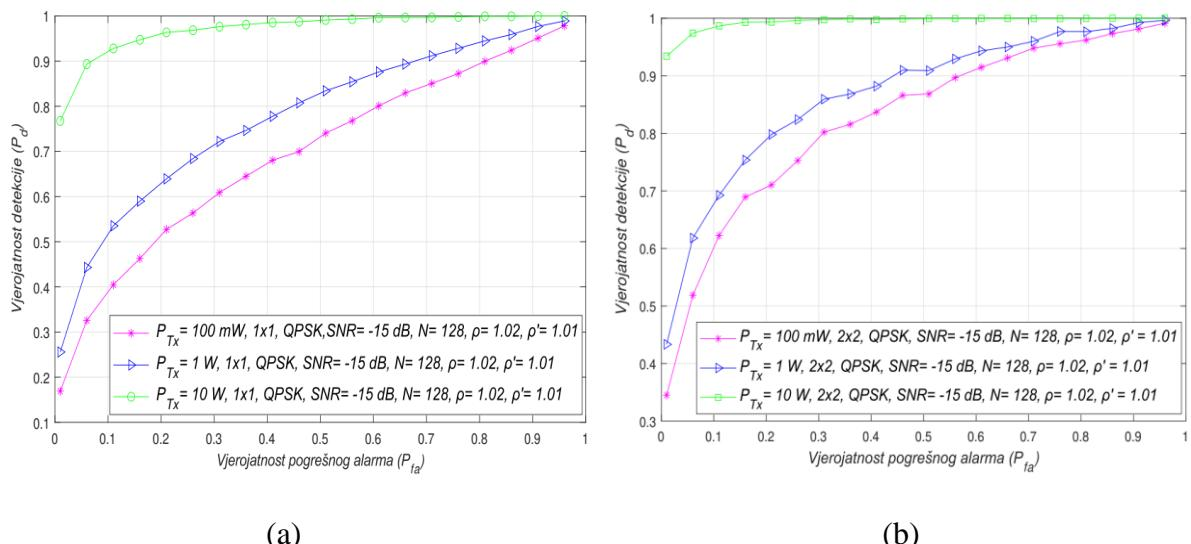
Slika 7.12. Krivulje radnih karakteristika prijemnika (ROC krivulje) metode detekcije energije (ED) za različite snage odašiljanja primarnog korisnika (PU) i omjera snage signala i šuma (SNR-a) od  $-15 \text{ dB}$  u: (a) SISO i (b)  $2 \times 2$  MIMO komunikacijskim sustavima
