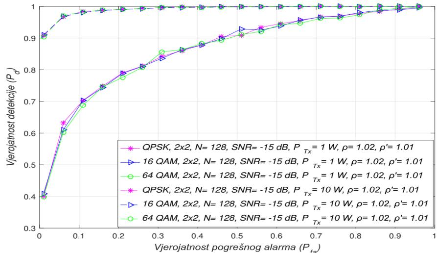
Slika 7.10. Krivulje radnih karakteristika prijemnika (ROC krivulje) ostvarene s metodom detekcije energije (ED) za MIMO sustav pod utjecajem različitih snaga odašiljanja (Tx) primarnog korisnika (PU) i modulacijskim shemama
