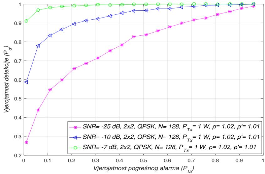
Slika 7.17. Međuvisnost detekcije i vjerojatnosti pogrešnog alarma za različite vrijednosti omjera snage signala i šuma (SNR-a)
