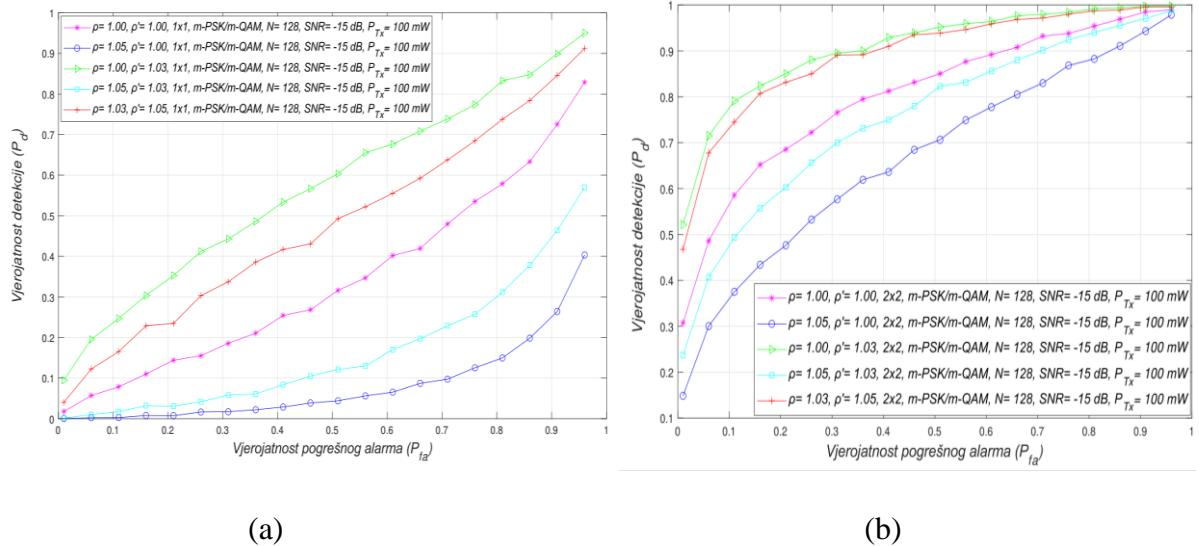
Slika 7.22. Krivulje radnih karakteristika prijemnika (ROC krivulje) za različite kombinacije faktora dinamičkog praga detekcije (DDT) i nesigurnosti snage šuma (NU) u: (a) SISO i (b)  $2 \times 2$  MIMO-OFDM sustavima karakteriziranim prijenosom signala s  $m$ -PSK/ $m$ -QAM modulacijom,  $N = 128$ ,  $SNR = -15$  dB i  $P_{tx} = 100$  mW
