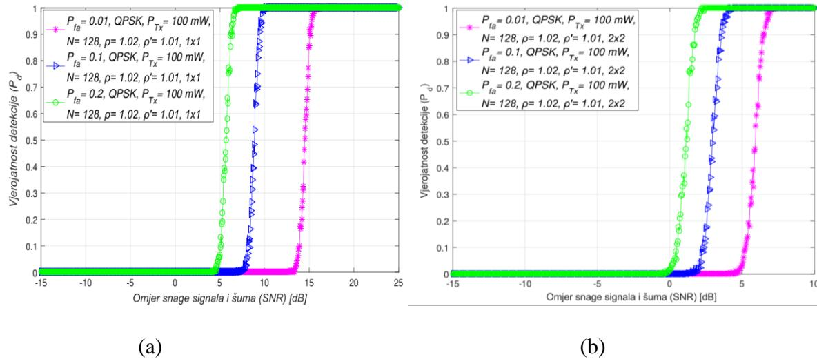
Slika 7.14. Međuvisnost vjerojatnosti detekcije i omjera snage signala i šuma (SNR-a) za različite vrijednosti vjerojatnosti pogrešnog alarma u: (a) SISO i (b) simetričnom MIMO prijenosnom sustavu
