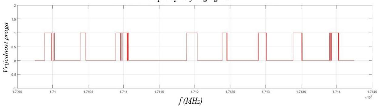
Slika 5.6. Periodogram i impulsi primljenog signala u frekvencijskom pojasu od 1710 MHz - 1714 MHz
