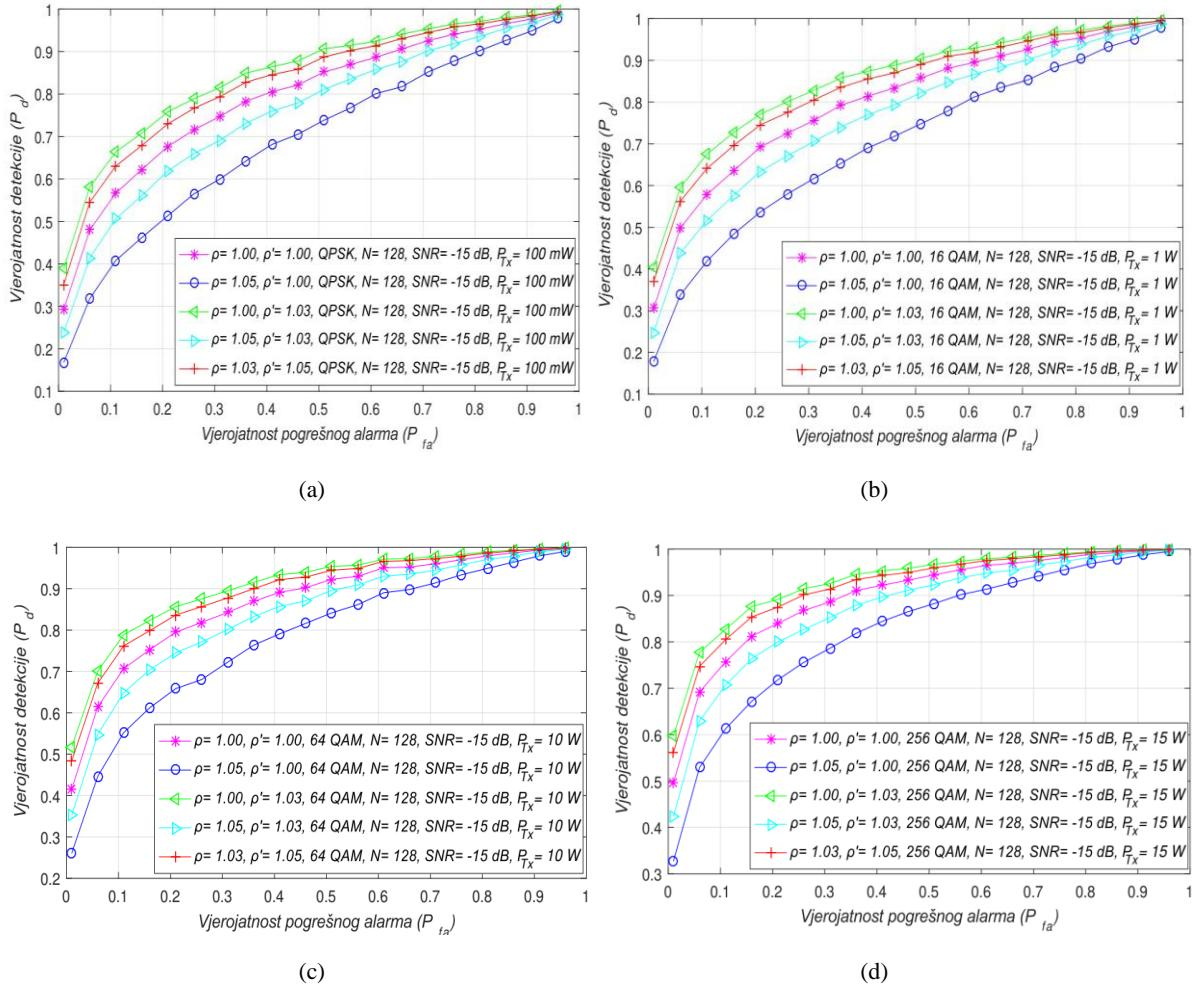
*Slika 6.5. Krivulje radnih karakteristika prijemnika (ROC krivulje) za signale u kombiniranom RA-MA sustavu s različitim kombinacijom faktora nesigurnosti snage šuma (NU) i dinamičkog praga detekcije (DDT) i prijenosa signala primarnog korisnika (PU) korištenjem: (a) QPSK modulacija pri snazi odašiljanja od 0,1 W; (b) 16 QAM modulacija pri snazi odašiljanja od 1 W; (c) 64 QAM modulacija pri snazi odašiljanja od 10 W i (d) 256 QAM modulacija pri snazi odašiljanja od 15 W*
