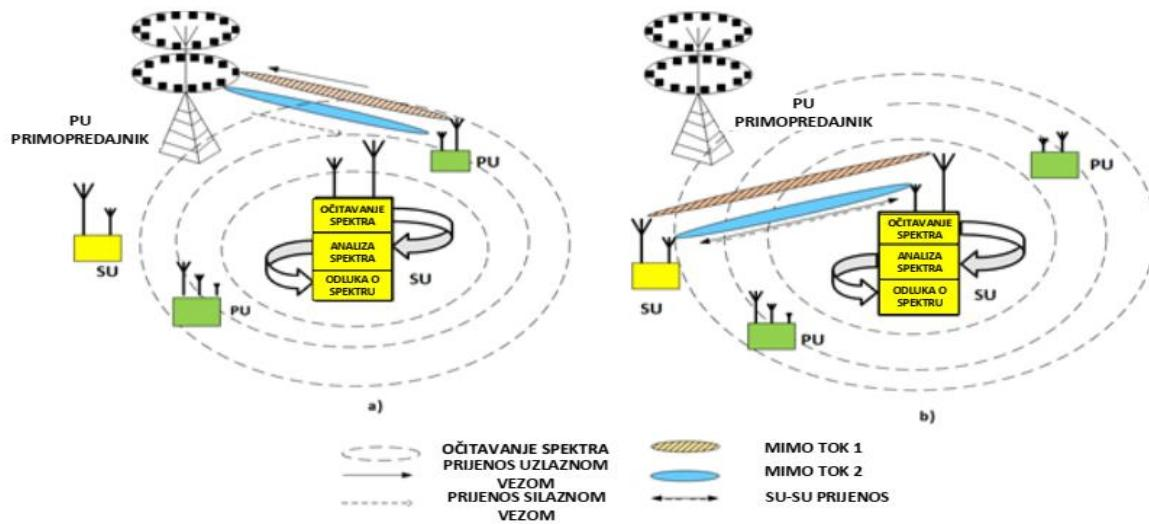
Slika 2.6. Rad kognitivnog radija u MIMO komunikacijskim sustavima za slučaj kada: a) sekundarni korisnik (SU) detektira spektr koji je zauzet od strane primarnog korisnika (PU) i b) sekundarni korisnik (SU) prenosi u frekvencijskom spektru koji nije zauzet od strane primarnog korisnika (PU)
