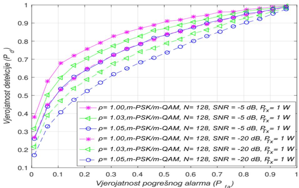
Slika 6.1. Krivulje radnih karakteristika prijemnika (ROC krivulje) za RA OFDM sustav temeljen na  $m\text{-PSK}/m\text{-QAM}$  modulacijama na koji utječu različite vrijednosti nesigurnosti snage šuma (NU) za dvije različite razine omjera snage signala i šuma (SNR)
