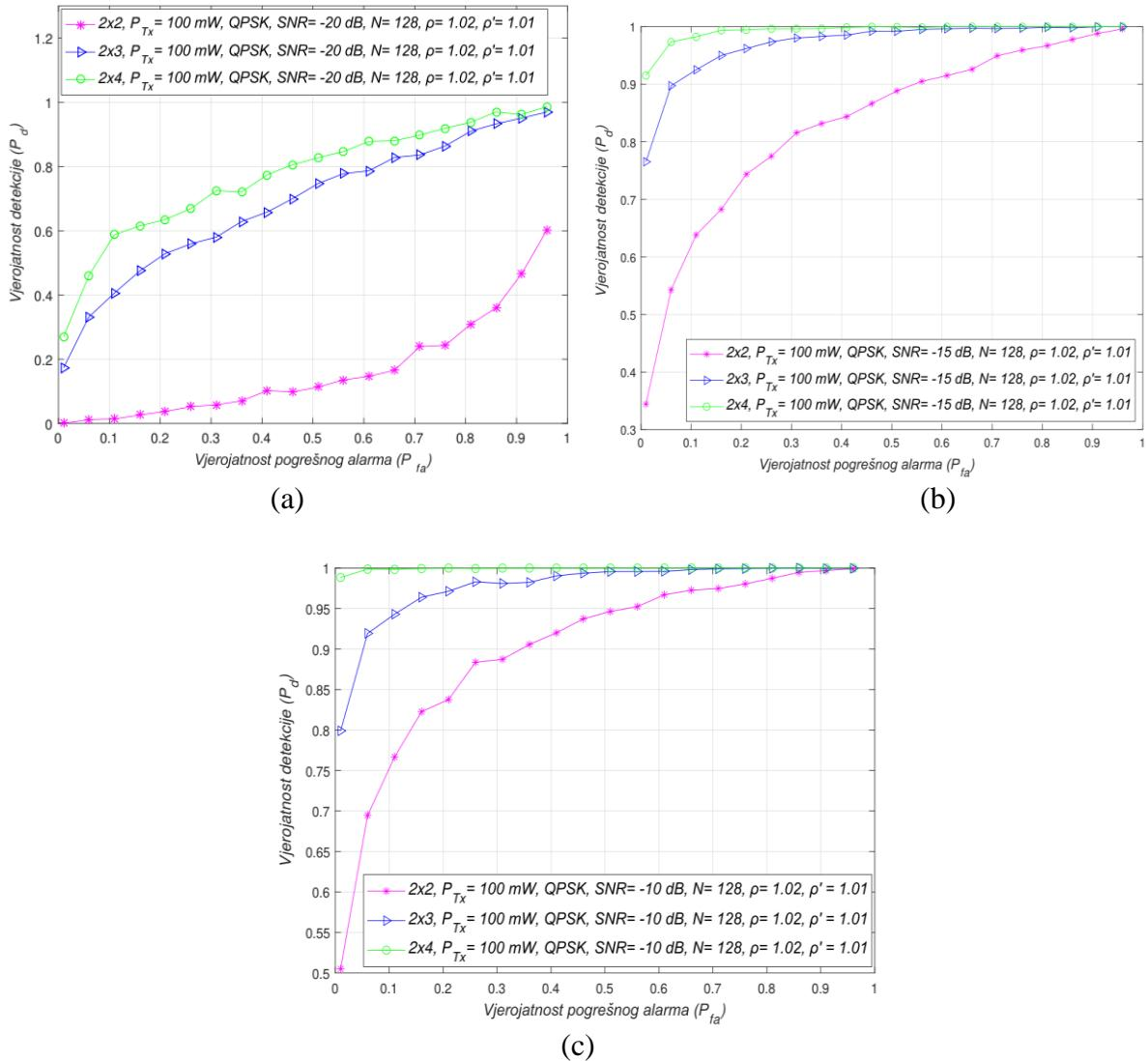
Slika 7.19. Krivulje radnih karakteristika prijemnika (ROC krivulje) analizirane metode detekcije energije (ED) za različite vrijednosti omjera snage signala i šuma (SNR-a) jednake:
