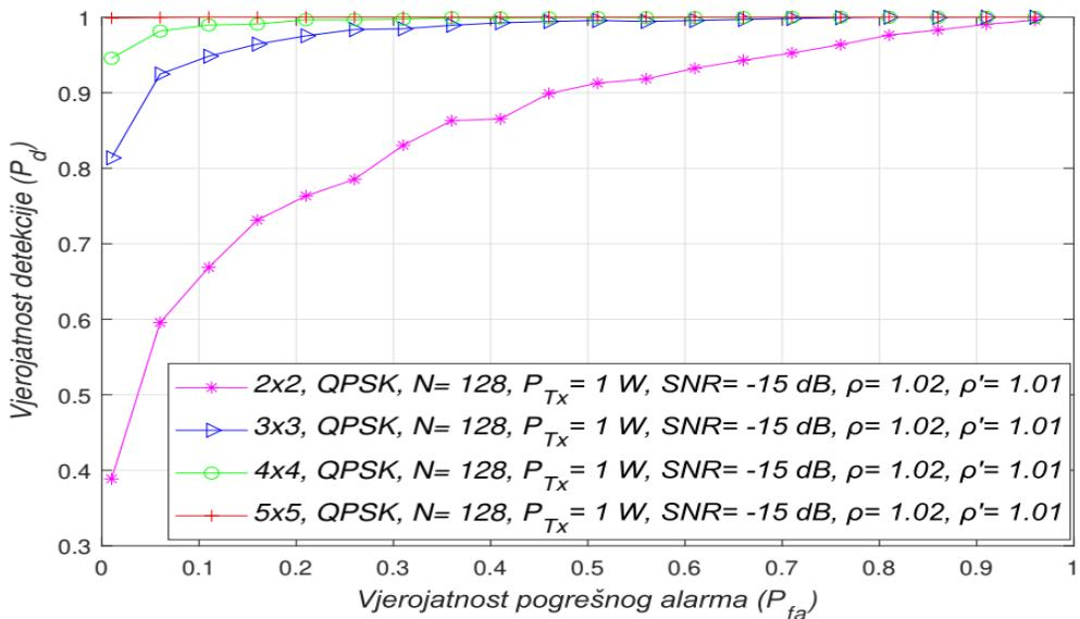
Slika 7.5. Krivulje radnih karakteristika prijemnika (ROC krivulje) za metodu detekcije energije (ED) ostvarene za simetrične  $2 \times 2$ ,  $3 \times 3$ ,  $4 \times 4$  i  $5 \times 5$  MIMO-OFDM komunikacijske sustave
