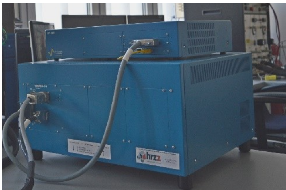
Slika 4.10. BioLogic SP-150 potenciostat s pripadajućim pojačalom signala VMP3B-10
