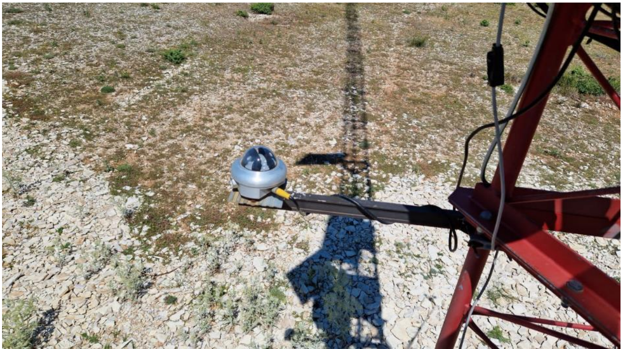
Slika 6-4 Piranometar Delta-T Sunshine montiran na mjernom stupu
