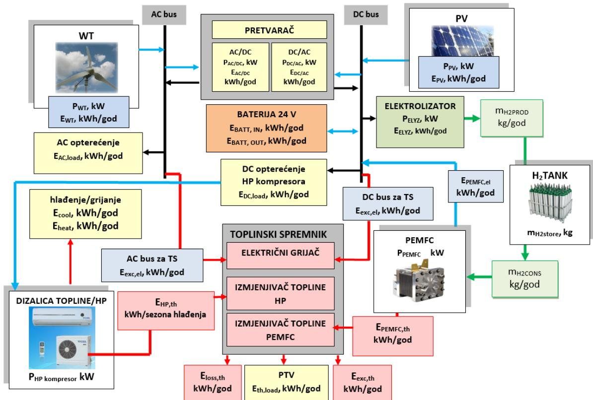
Slika 8. Shematski prikaz tokova energije u HRES/H<sub>2</sub> između komponenti
