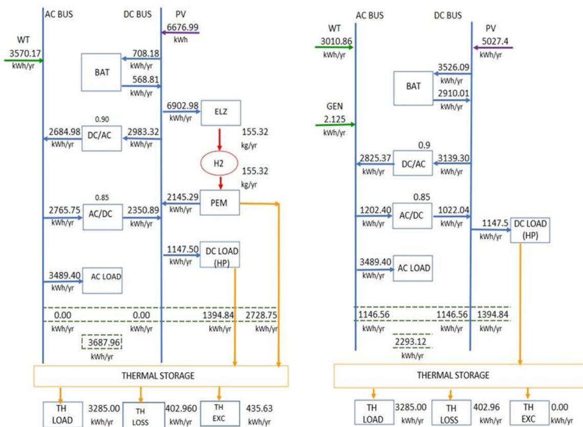
Slika 10. Raspodjela tokova energije u HRES/H<sub>2</sub> (lijevo) i HRES/BATT (desno) u rezimu posluživanja profila AC I
