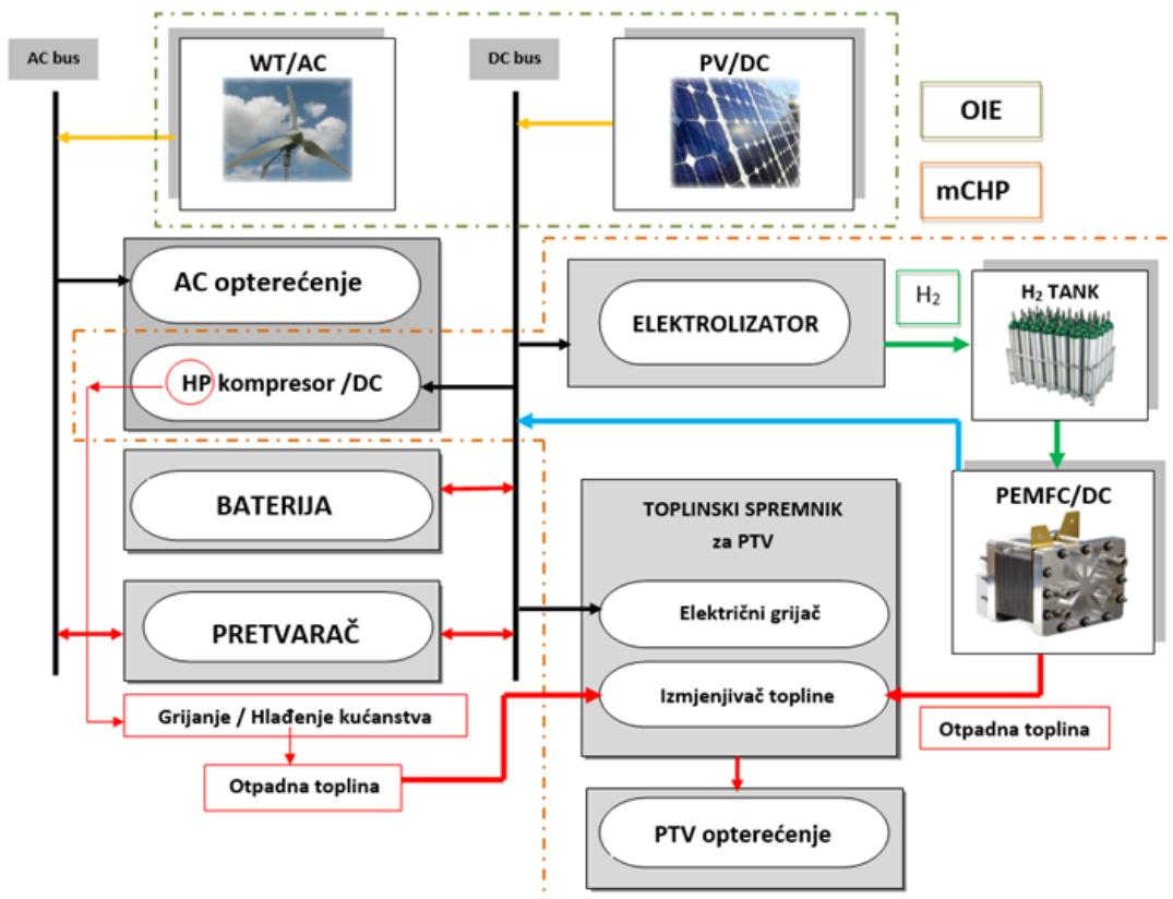
Slika 1. Modelirani mikro-kogeneracijski samostalni HRES/H<sub>2</sub> sustav [53-54]
