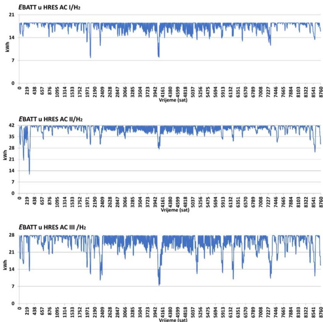
Slika 13. Satna dinamika pohrane energije u baterijskom spremniku u HRES/H<sub>2</sub> za režime posluživanja opterećenja AC I-II-III
