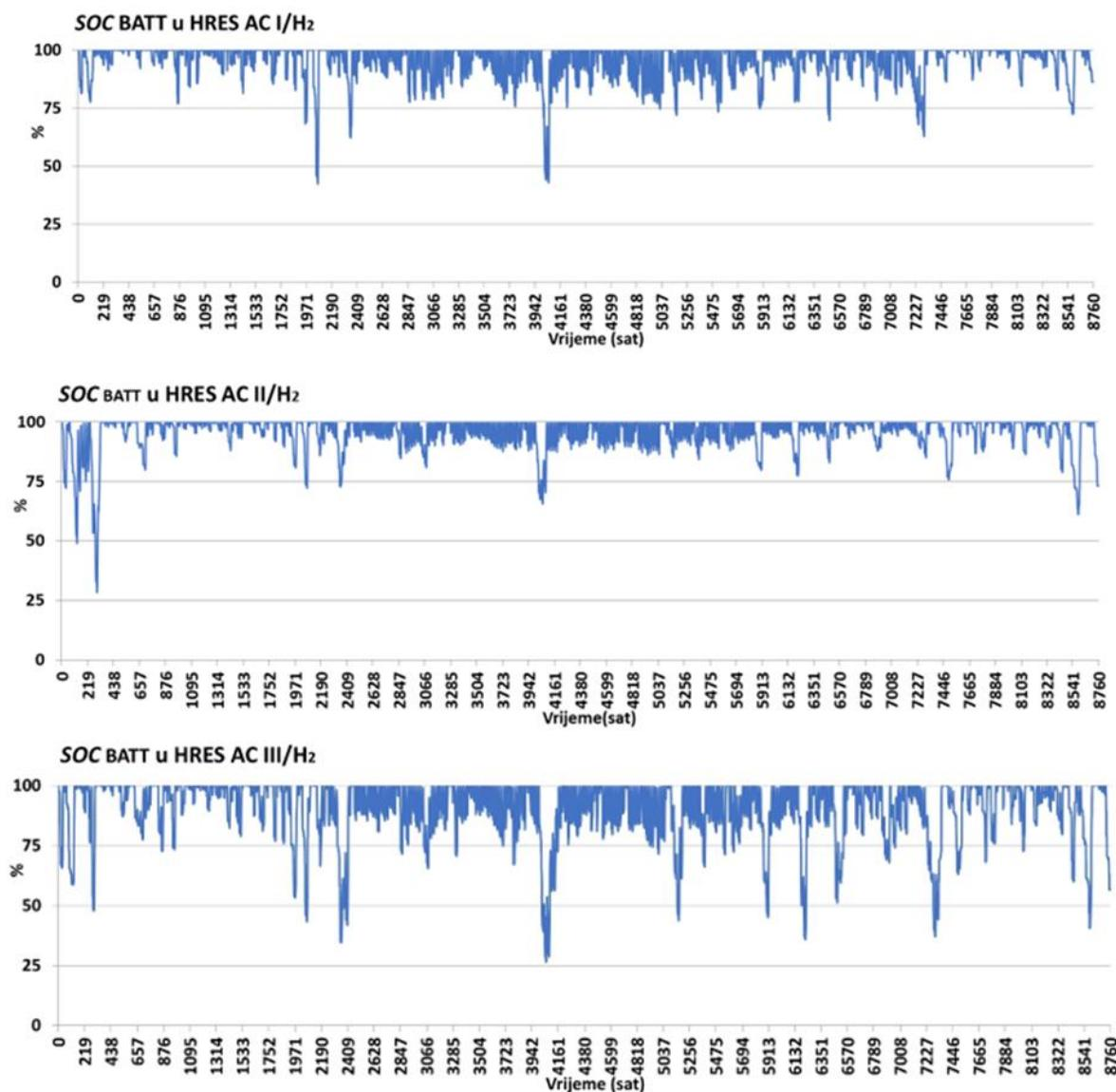
*Slika 18. Stanje napunjenosti baterijskog spremnika HRES/H<sub>2</sub> u režimu rada AC I-II-III*
