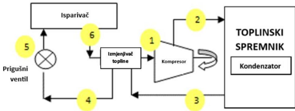
Slika 6. Shematski prikaz komponenti dizalice topline u pripremi PTV
