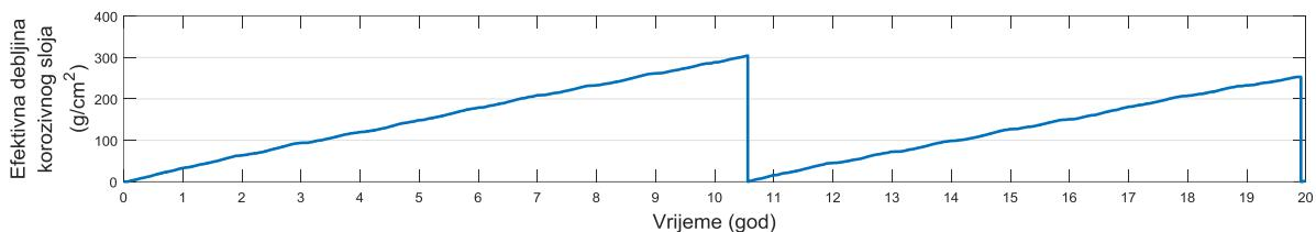
Slika 6.25: Dinamika prirasta efektivne debljine korozivnog sloja, razmatrani slučaj A-2
