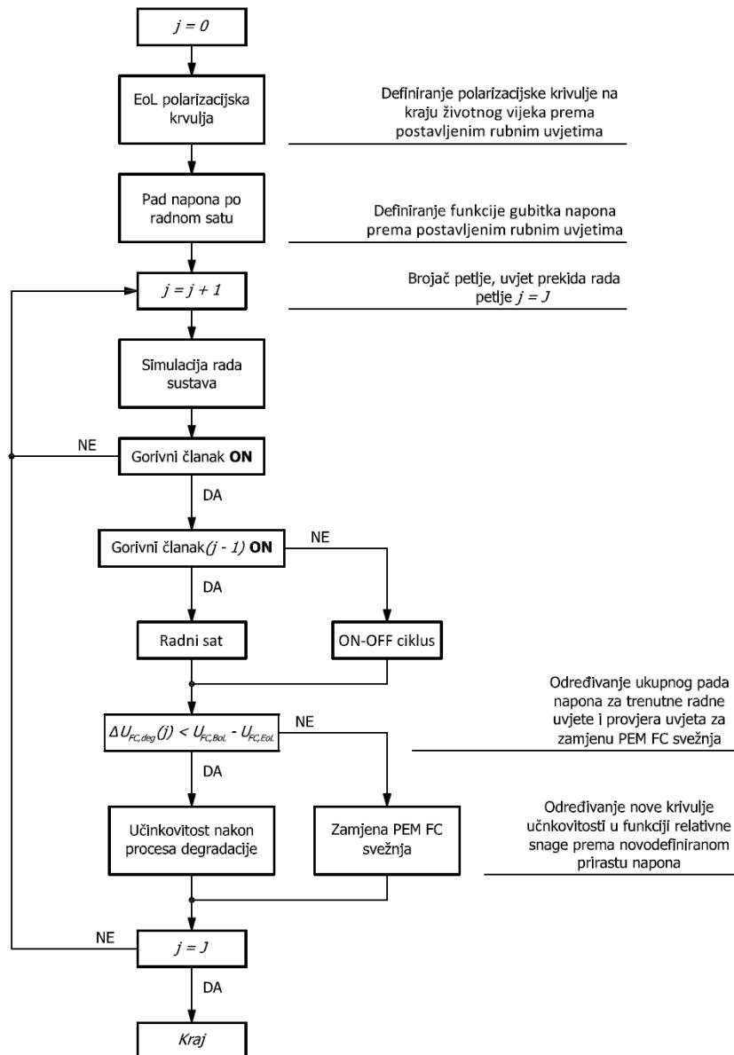
Slika 3.22: Dijagram toka procesa degradacije PEM FC-a
