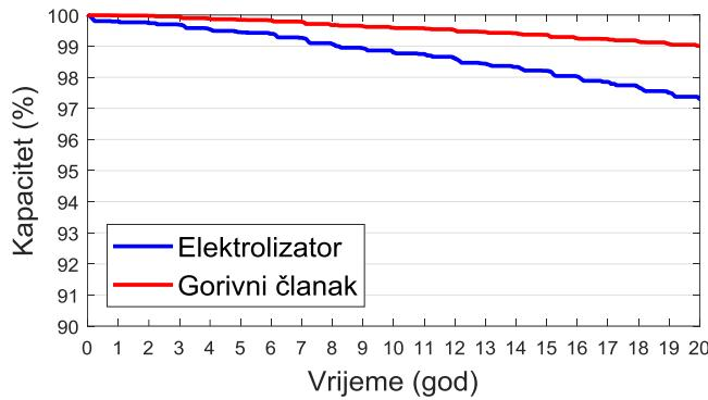
Slika 6.40: Dinamika gubitka kapaciteta elektrolizatora i gorivnog članka, razmatrani slučaj A-3
