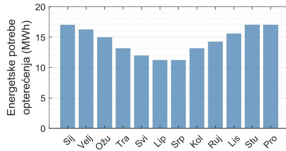
Slika 3.10: Prosječne mjesечne energetske potrebe impulsnog profila opterećenja
