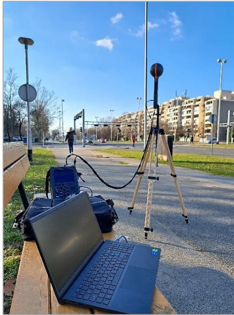
Slika 8.22 Korištena mjerna oprema (analizatora frekvencijskog spektra, izotropna prijamna antena, nevodljivi tronožac, prijenosno računalo te koaksijalni i LAN kabel)
