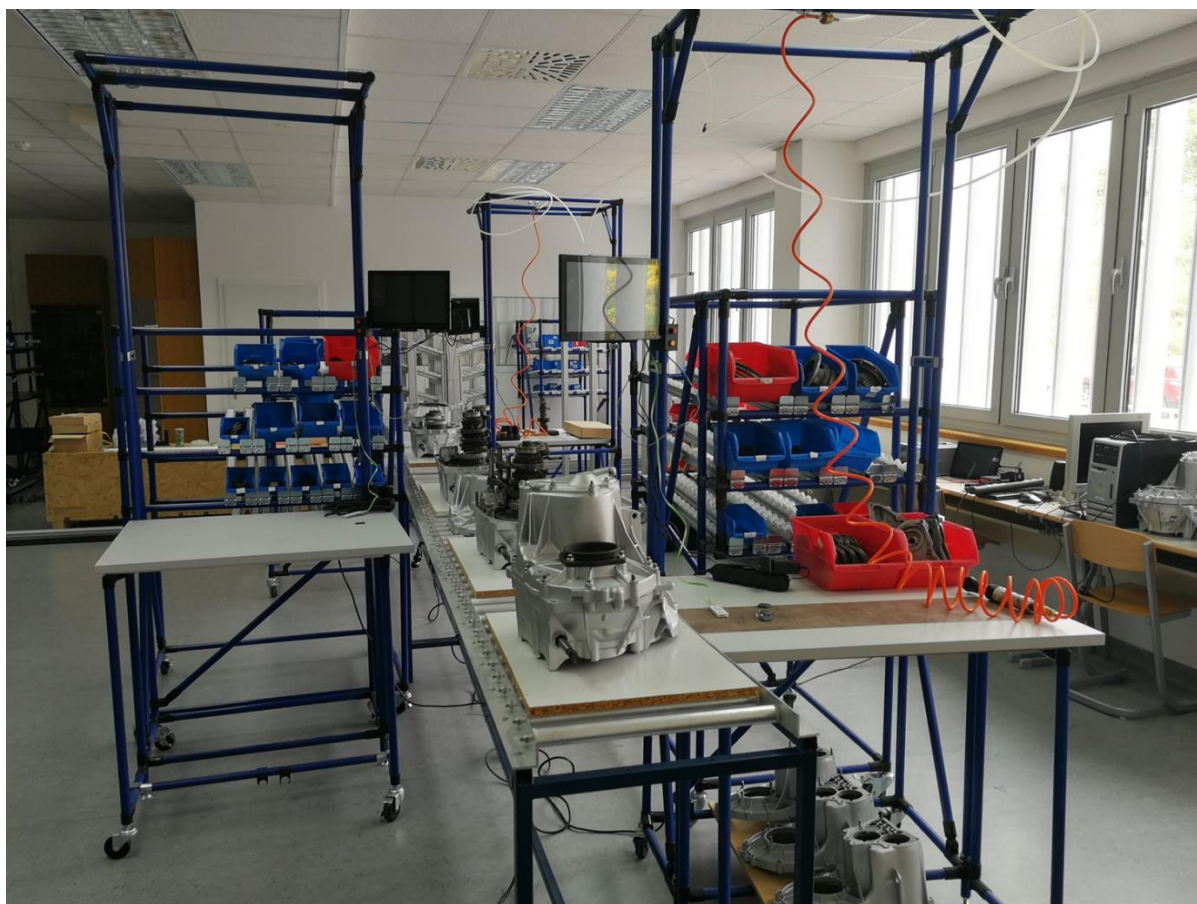
Slika 4.11. Montažna linija mjenjačke kutije automobila
