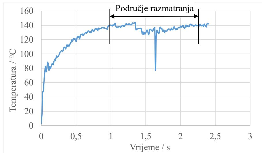
Slika 7.6. Temperatura u zoni rezanja: eksperimentalni rezultati
