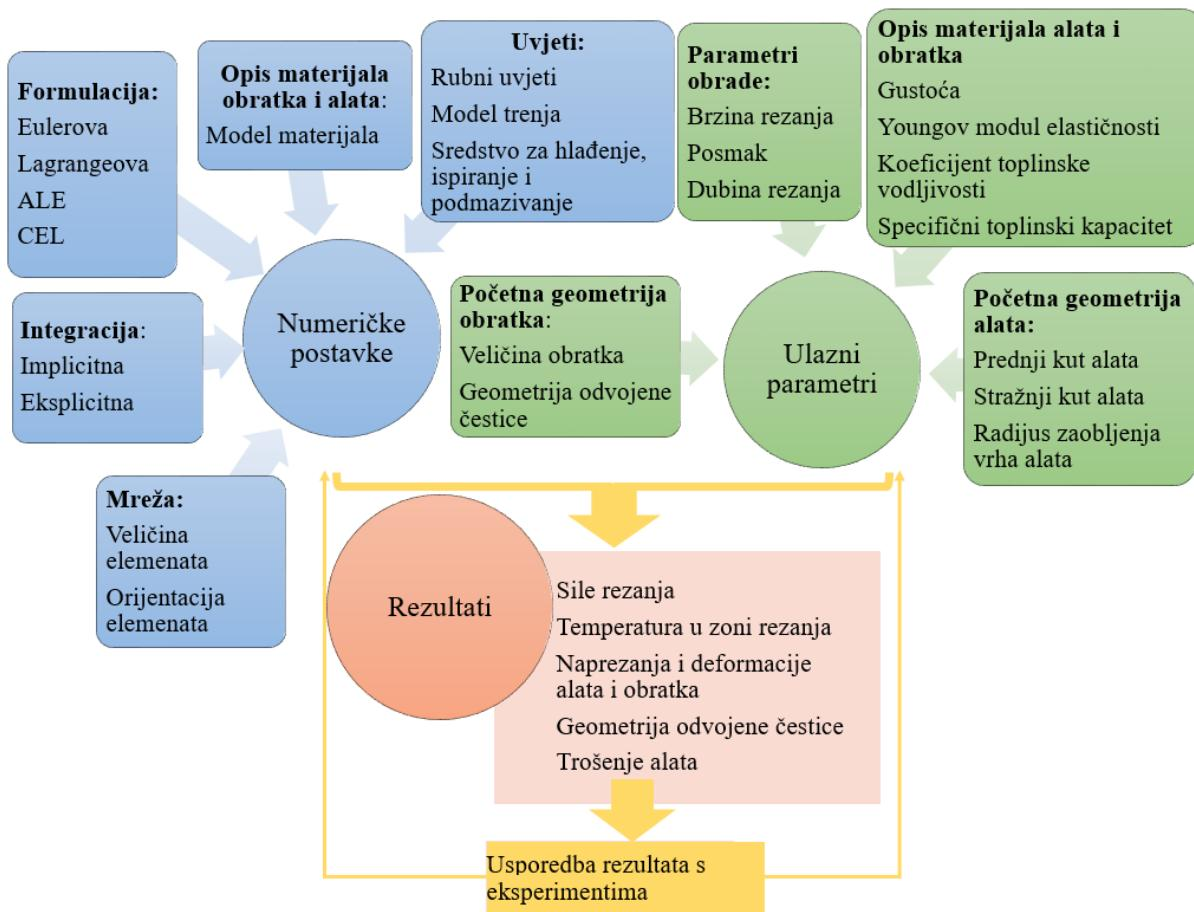
Slika 4.4. Ulagani parametri, numeričke postavke i rezultati numeričkih simulacija
