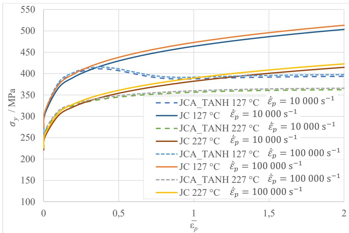
Slika 9.20. Ovisnost naprezanja tečenja o ekvivalentnoj plastičnoj deformaciji za različite zakone očvršćivanja pri razmatranoj vrijednosti  $\dot{\varepsilon}_p = 10\ 000\ s^{-1}$  i  $\dot{\varepsilon}_p = 100\ 000\ s^{-1}$
