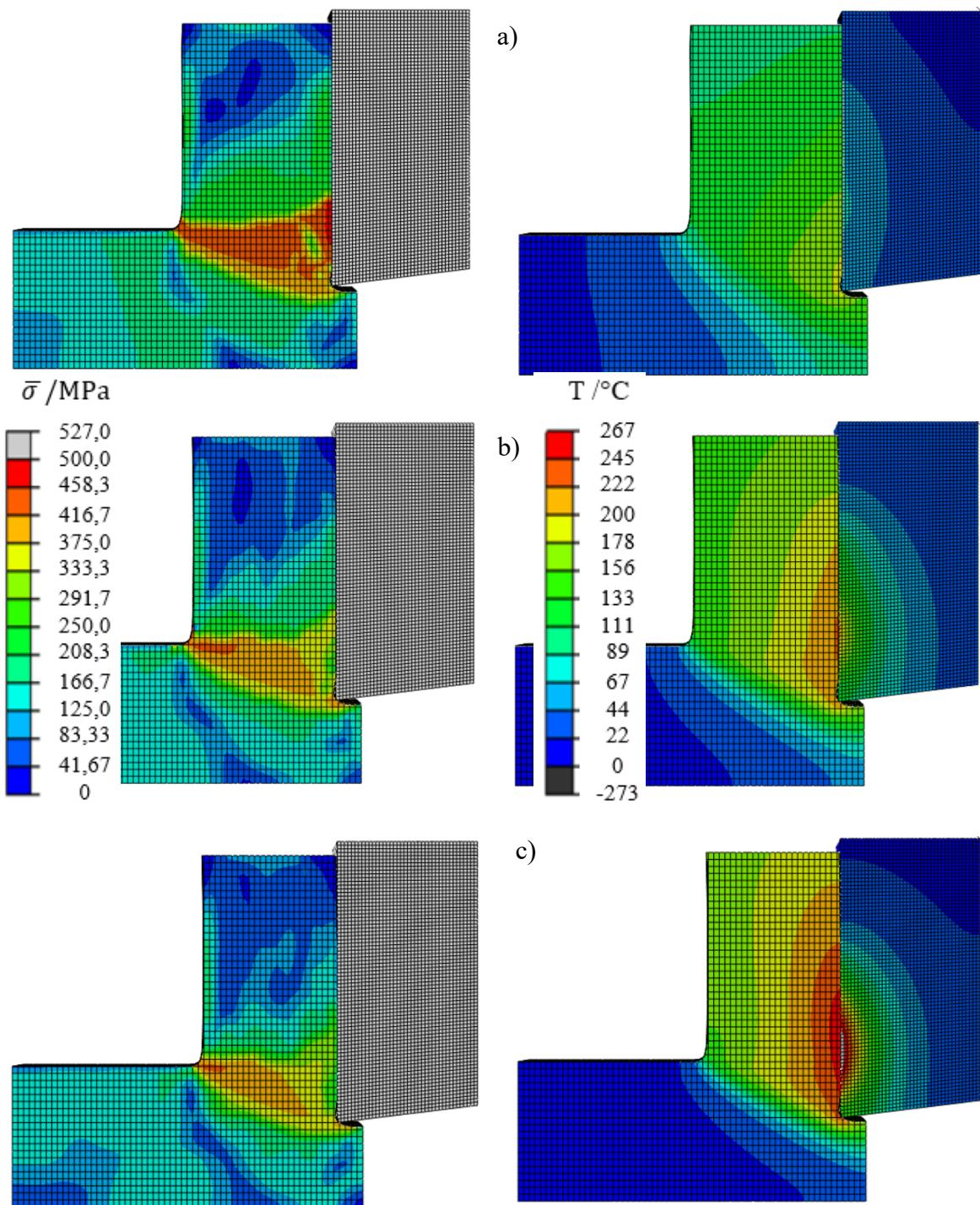
Slika 9.16. Raspodjela ekvivalentnog naprezanja u obratku i odvojenoj čestici te raspodjela temperature u zoni rezanja predviđene numeričkim postupkom za:
