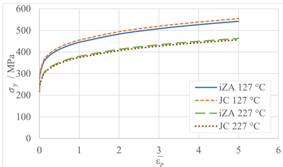
Slika 9.4. Ovisnost naprezanja tečenja o ekvivalentnoj plastičnoj deformaciji za različite zakone očvršćivanja pri razmatranoj vrijednosti  $\dot{\varepsilon}_p = 1000 \text{ s}^{-1}$
