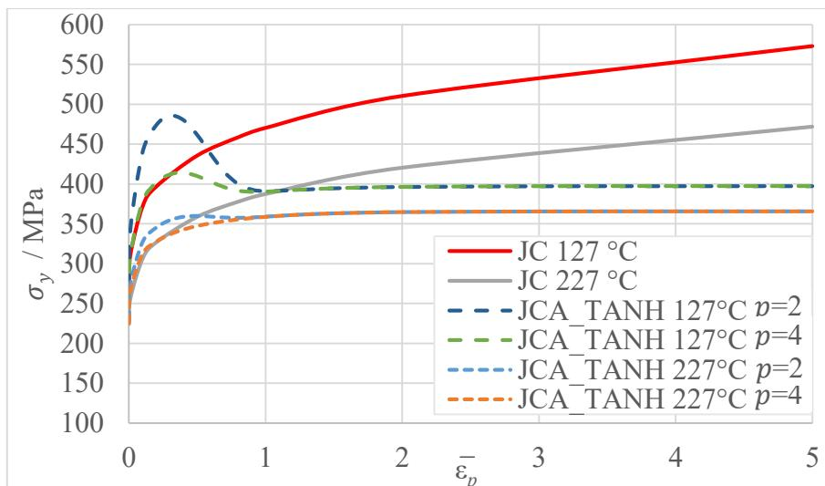
Slika 9.19. Ovisnost naprezanja tečenja o ekvivalentnoj plastičnoj deformaciji za različite zakone očvršćivanja pri razmatranoj vrijednosti  $\dot{\varepsilon}_p = 50\ 000\ s^{-1}$
