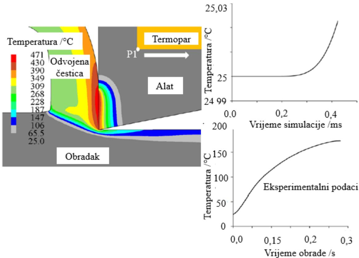
Slika 4.5. Usporedba temperature u zoni rezanja predviđene numeričkim simulacijama i dobivene eksperimentalnim mjeranjima [5]
