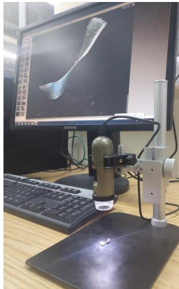
*Slika 5.7. Oprema za mjerjenje geometrije odvojene čestice*
