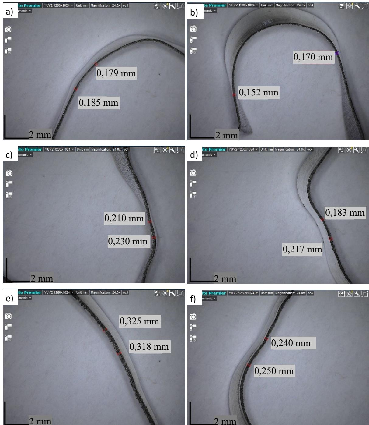
Slika 5.17. Primjeri mjerjenja debljine odvojene čestice za različite parametre obrade:
