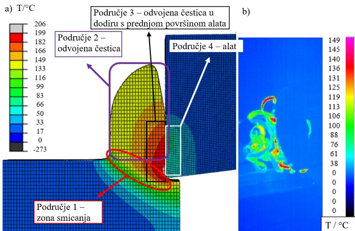
Slika 7.5. Raspolaganje temperature u zoni rezanja: a) rezultati dobiveni numeričkim modeliranjem, b) eksperimentalni rezultati
