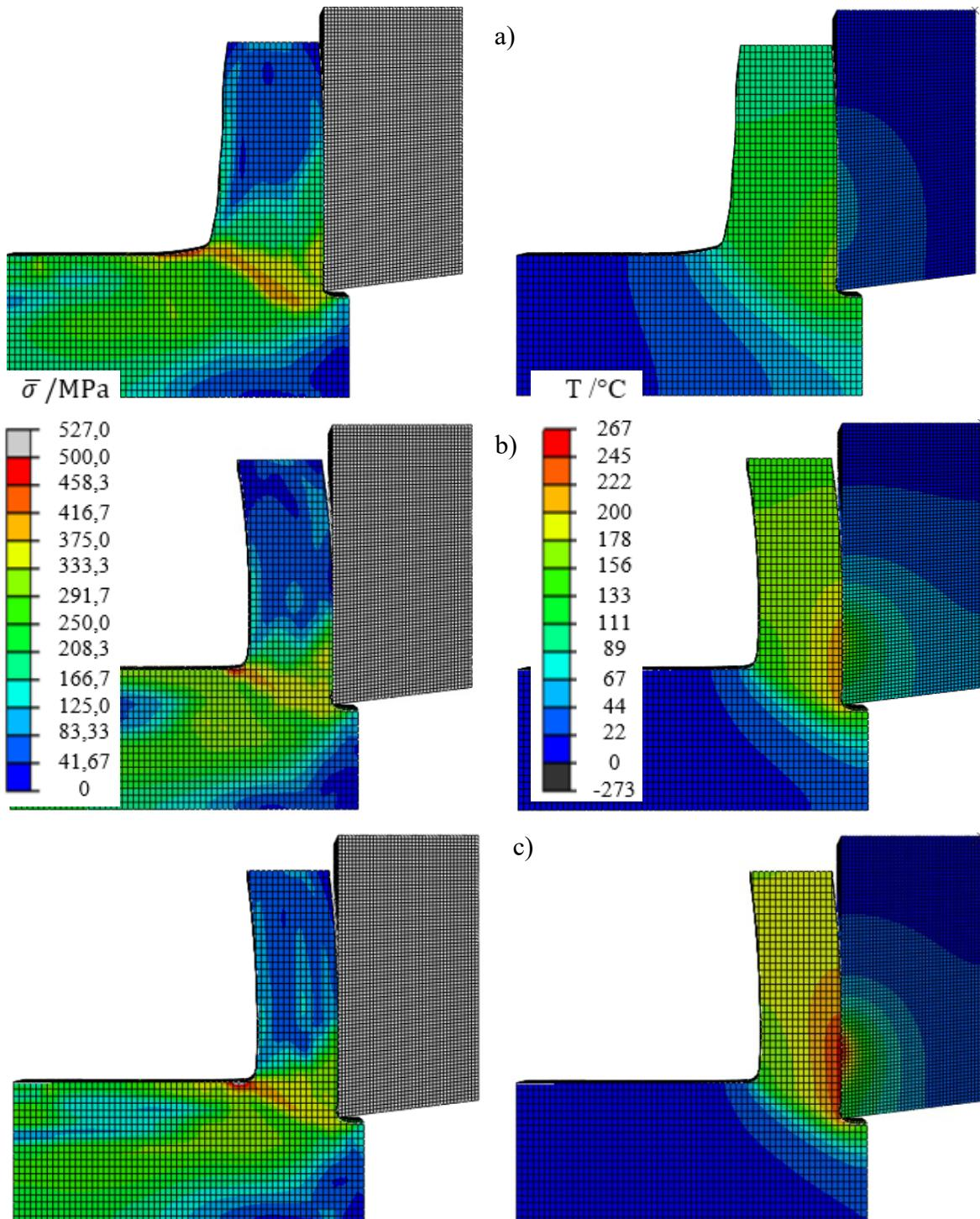
Slika 9.24. Raspodjela ekvivalentnog naprezanja u obratku i odvojenoj čestici te raspodjela temperature u zoni rezanja predviđene numeričkim postupkom za:
