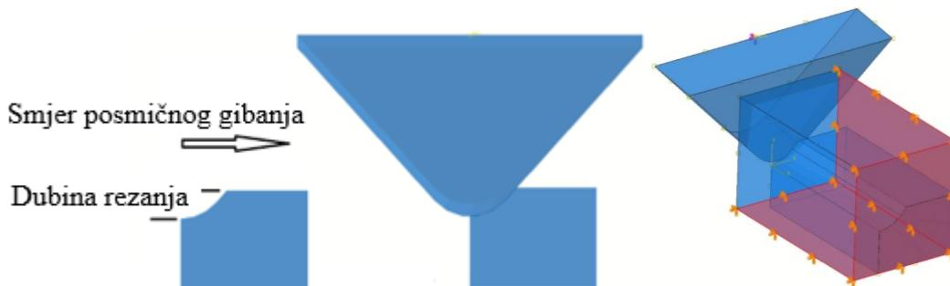
*Slika 4.7. Shematski prikaz rezne pločice i obratka [127]*
