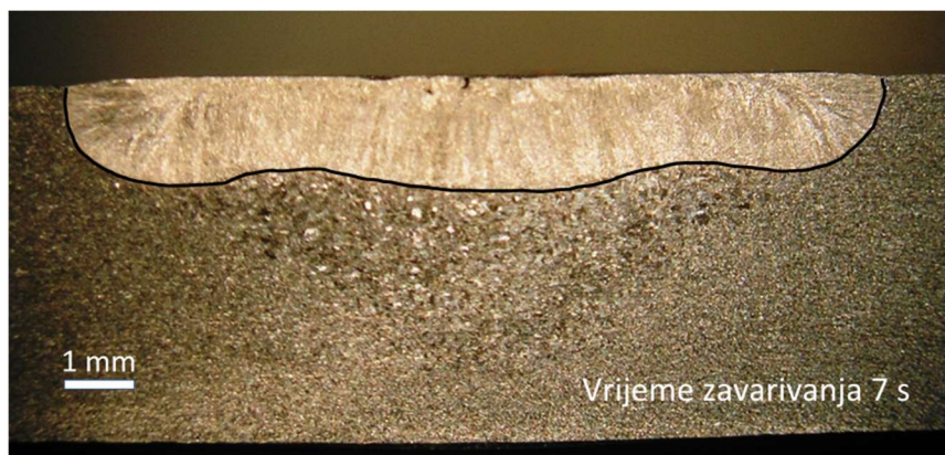
Slika 5.3 Uobičajen oblik zone taljenja za vrijeme zavarivanja od 7 s
