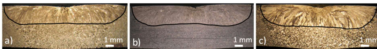
Slika 5.70 Zona taljenja za uzorke s površinom a) u izvornom stanju, b) s brušenom gornjom stranom i c) s brušenom gornjom i donjom stranom; vrijeme zavarivanja 14 s
