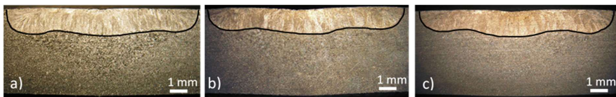
Slika 5.65 Zona taljenja za uzorke s površinom u a) izvornom stanju, b) brušenom gornjom stranom i c) brušenom gornjom i donjom stranom; vrijeme zavarivanja 7 s
