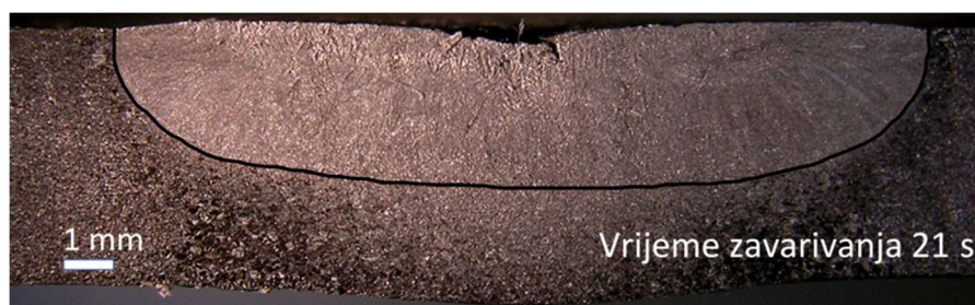
Slika 5.16 Uobičajen oblik zone taljenja za vrijeme zavarivanja od 21 s
