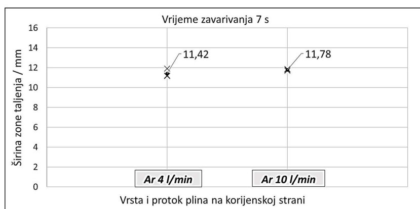
Slika 5.33 Širine zone taljenja za različite protoke argona na korijenskoj strani zavara
