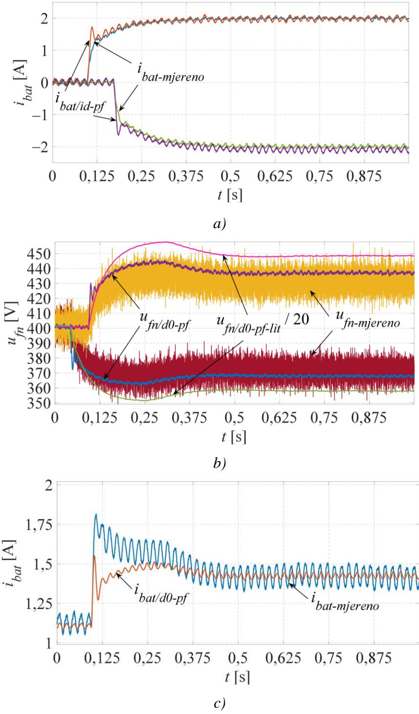
Slika 4.3. Eksperimentalno ispitivanje: prijenosne funkcije struje  $i_{bat}$  po struji  $i_d$  (a), prijenosne funkcije napona  $u_{fn}$  po faktoru  $d_0$  (b), prijenosne funkcije struje  $i_{bat}$  po faktoru  $d_0$  (c)
