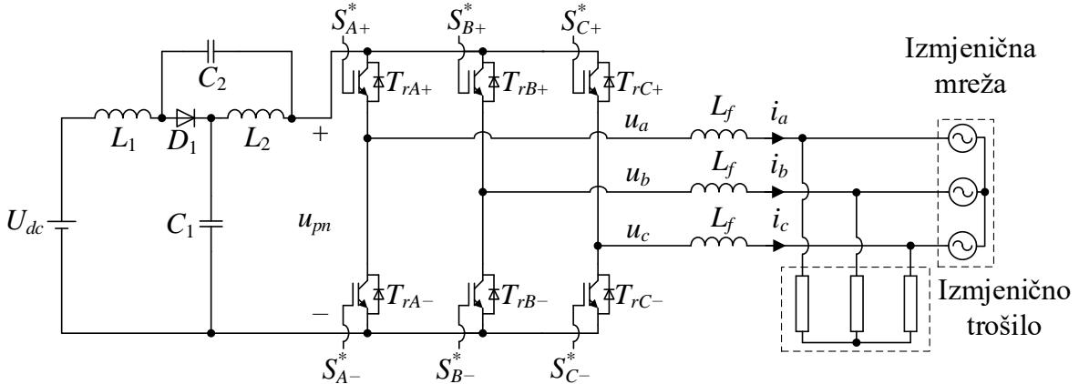
Slika 1.1. Topologija trofaznog izmjenjivača kvazi Z-tipa [25]
