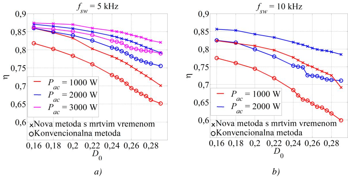
Slika 2.8. Korisnost izmjenjivača kvazi Z-tipa u ovisnosti o faktoru trajanja prostrijelnog stanja za dvije razmatrane metode utiskivanja prostrijelnog stanja pri sklopnoj frekvenciji 5 kHz (a) i 10 kHz (b)
