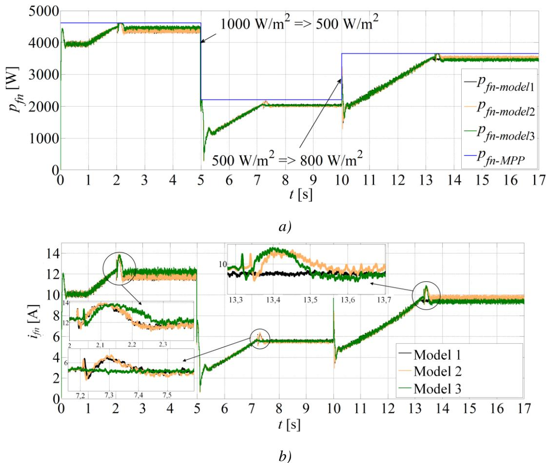
Slika 3.12. Dinamički odzivi snage fotonaponskog izvora (a) i struje fotonaponskog izvora (b) pri skokovitim promjenama osunčanosti [II]
