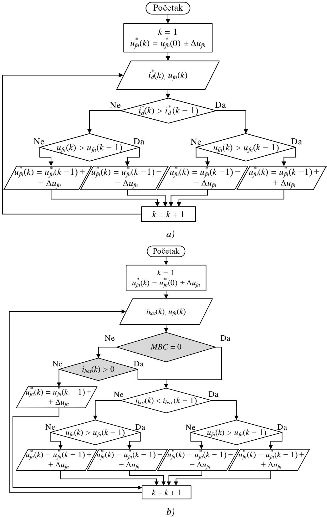
Slika 4.5. Dijagrami toka algoritma za praćenje točke maksimalne snage: u spoju s mrežom (a) i u otočnom načinu rada (b) [V]
