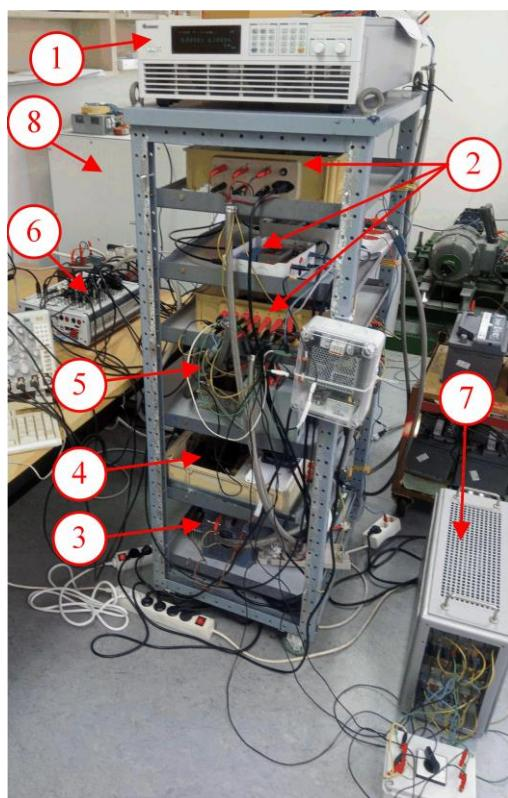
*Slika 1.2. Fotografija laboratorijske makete izmjenjivača kvazi Z-tipa napajanog iz programabilnog istosmjernog izvora i baterija [V]*
