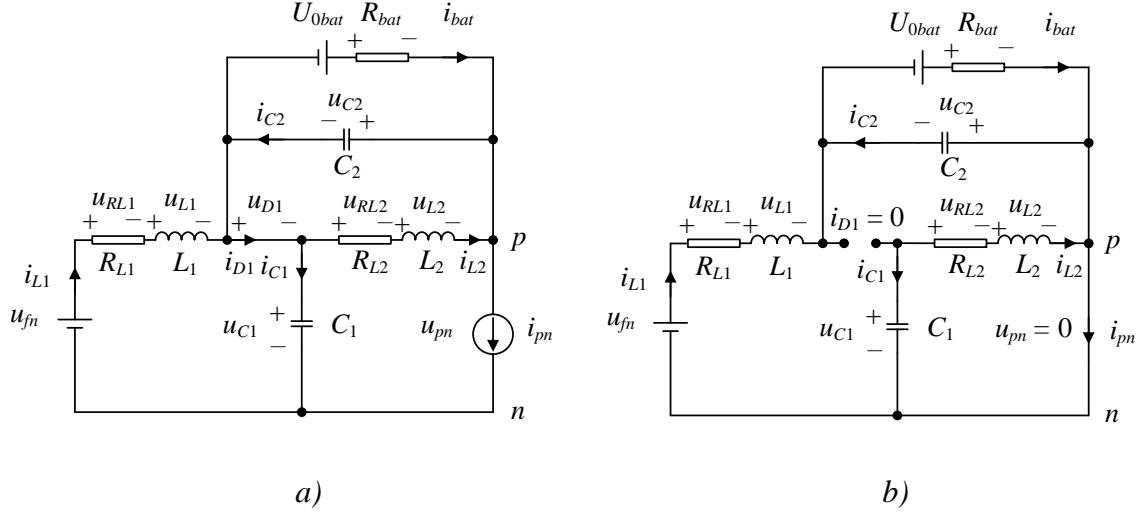
Slika 4.2. Nadomjesna shema izmjenjivača kvazi Z-tipa napajanog iz fotonaponskog izvora s baterijama spojenim paralelno s kondenzatorom  $C_2$  tijekom aktivnih i nultih stanja (a) i prostrijelnog stanja (b)
