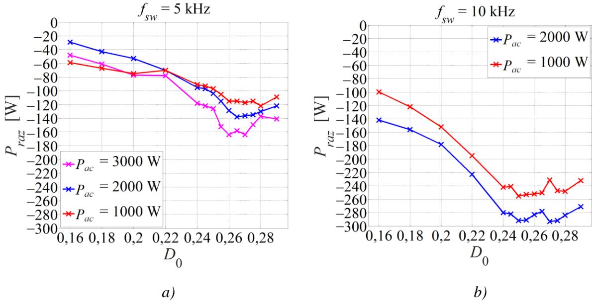
Slika 2.7. Razliku u gubicima izmjenjivača kvazi Z-tipa u ovisnosti o faktoru trajanja prostrijelnog stanja pri sklopnjoj frekvenciji 5 kHz (a) i 10 kHz (b)
