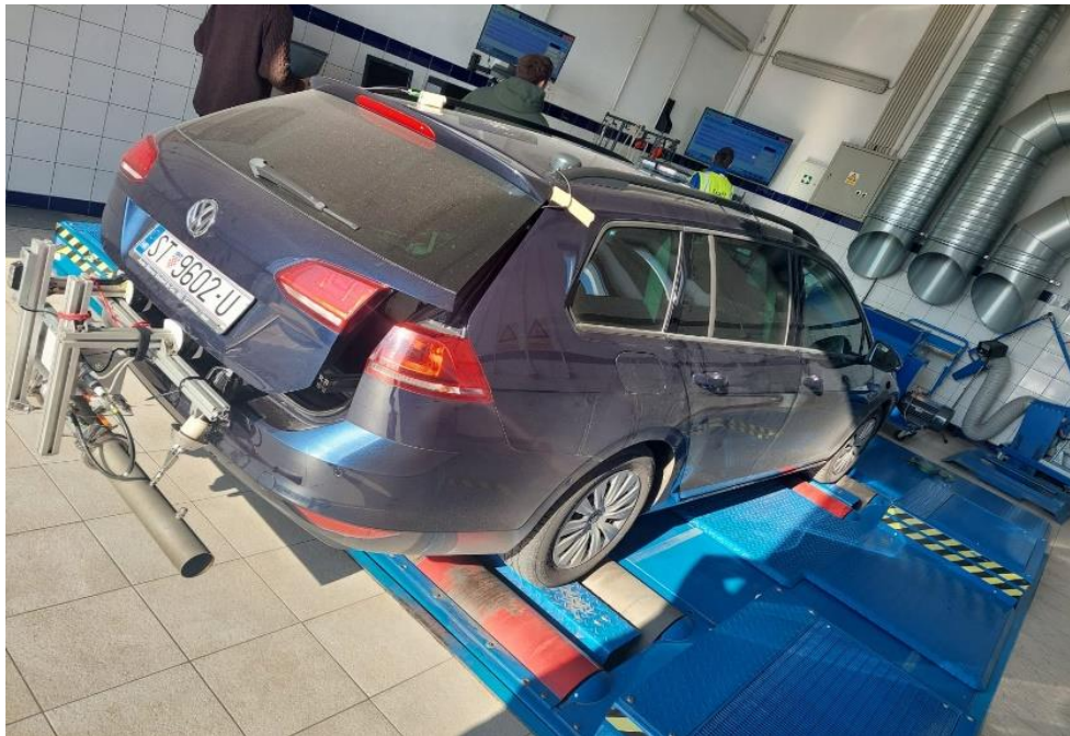
Slika 46. Vozilo na ispitnim valjcima s ugrađenom mjernom opremom.
