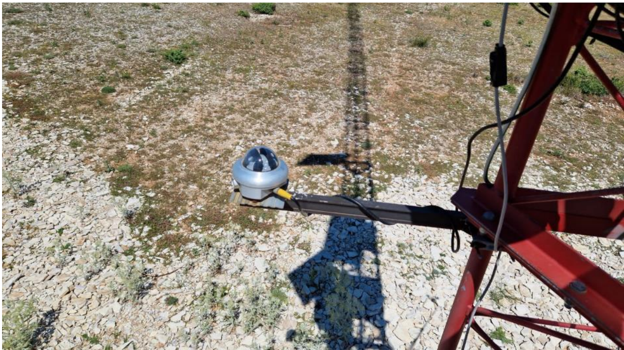
Slika 6-4 Piranometar Delta-T Sunshine montiran na mjernom stupu
