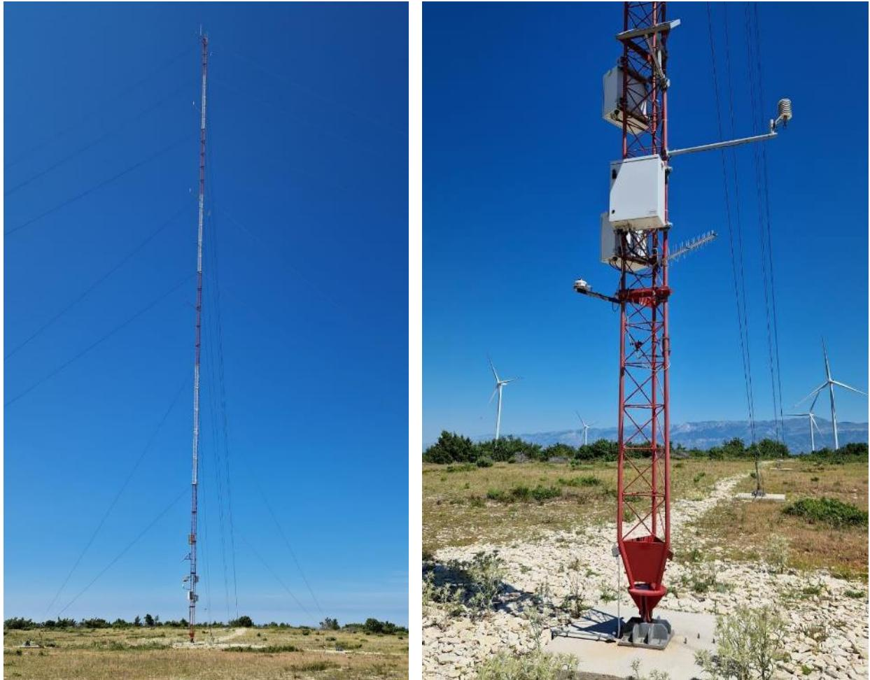
Slika 6-3 Mjerni stup (lijevo) i lokacija mjerne i registracijske opreme u donjem dijelu stupa (desno)
