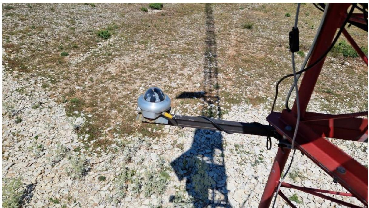
Slika 6-4 Piranometar Delta-T Sunshine montiran na mjernom stupu
