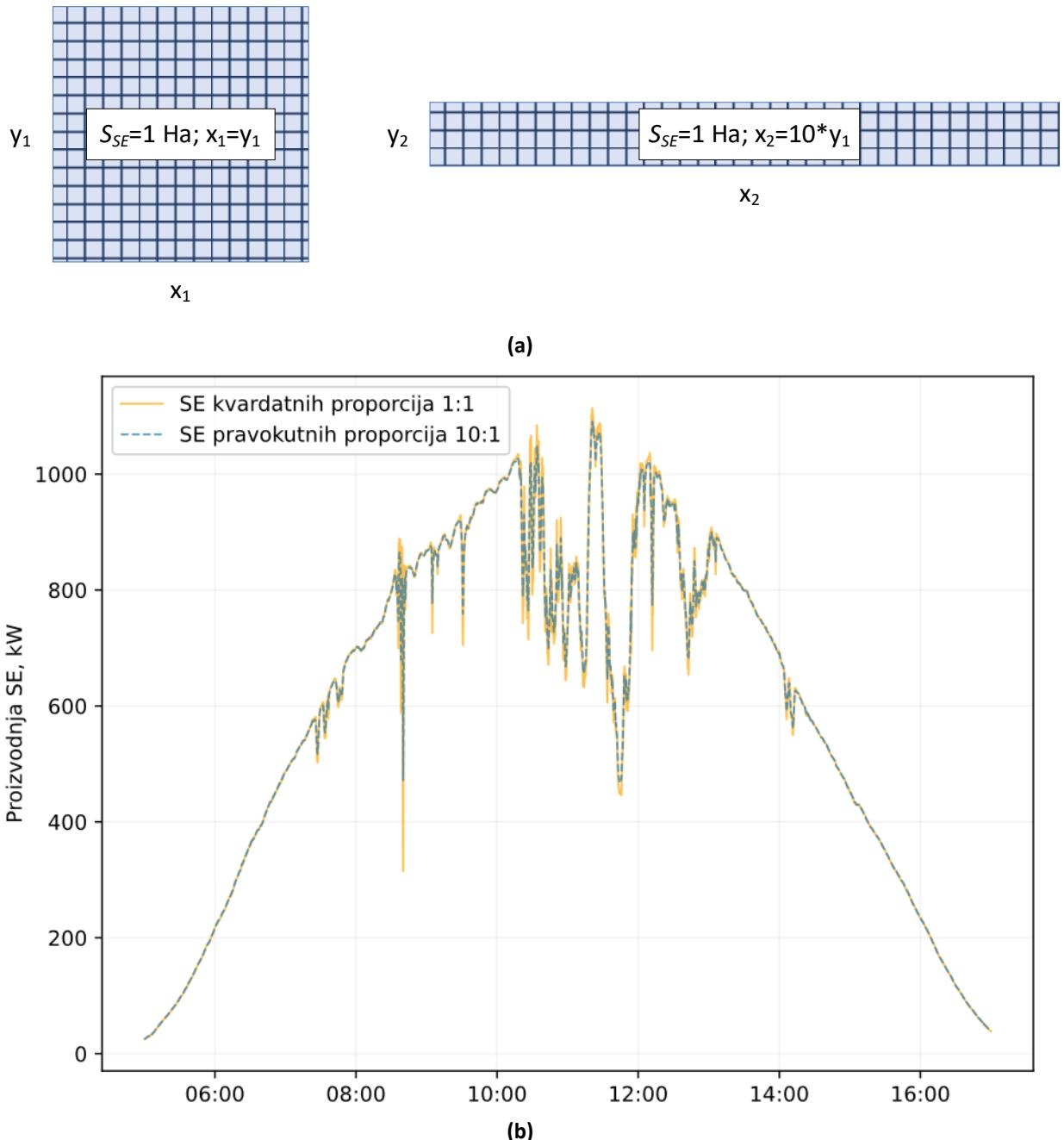
*Slika 5-36 Promjene fluktuacija proizvodnje za različite prostorne konfiguracije SE (a) kvadratna konfiguracija (lijevo) i pravokutna konfiguracija uz omjer stranica 10:1 (desno) i (b) vremenska serija proizvodnje SE dobivene modelom zasnovanim na [49]*
