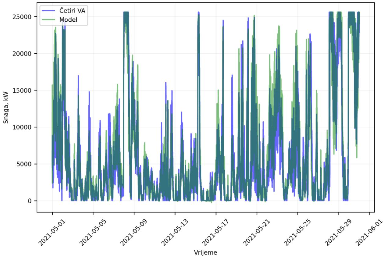
Slika 5-31 Usporedba ostvarene proizvodnje četiri VA nazine snage 3200 kW i proizvodnja dobivena predloženim modelom
