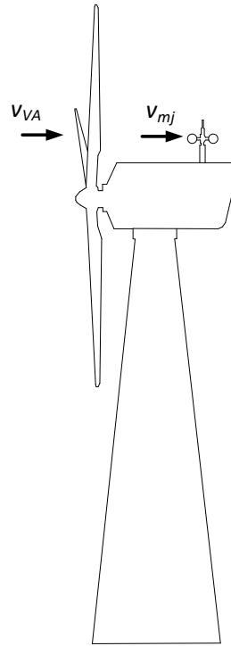
Slika 5-7 Ulagana brzina vjetra  $v_{VA}$  i mjerena brzina vjetra na anemometru  $v_{mj}$
