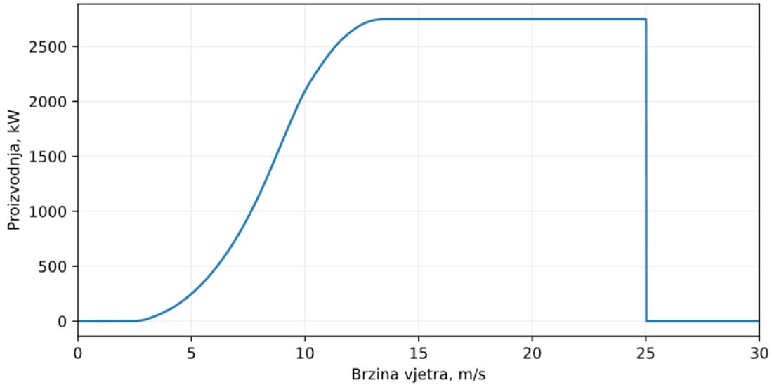
Slika 2-4 P-v karakteristika vjetroagregata (VA) tipa General Electric 2.75-103
