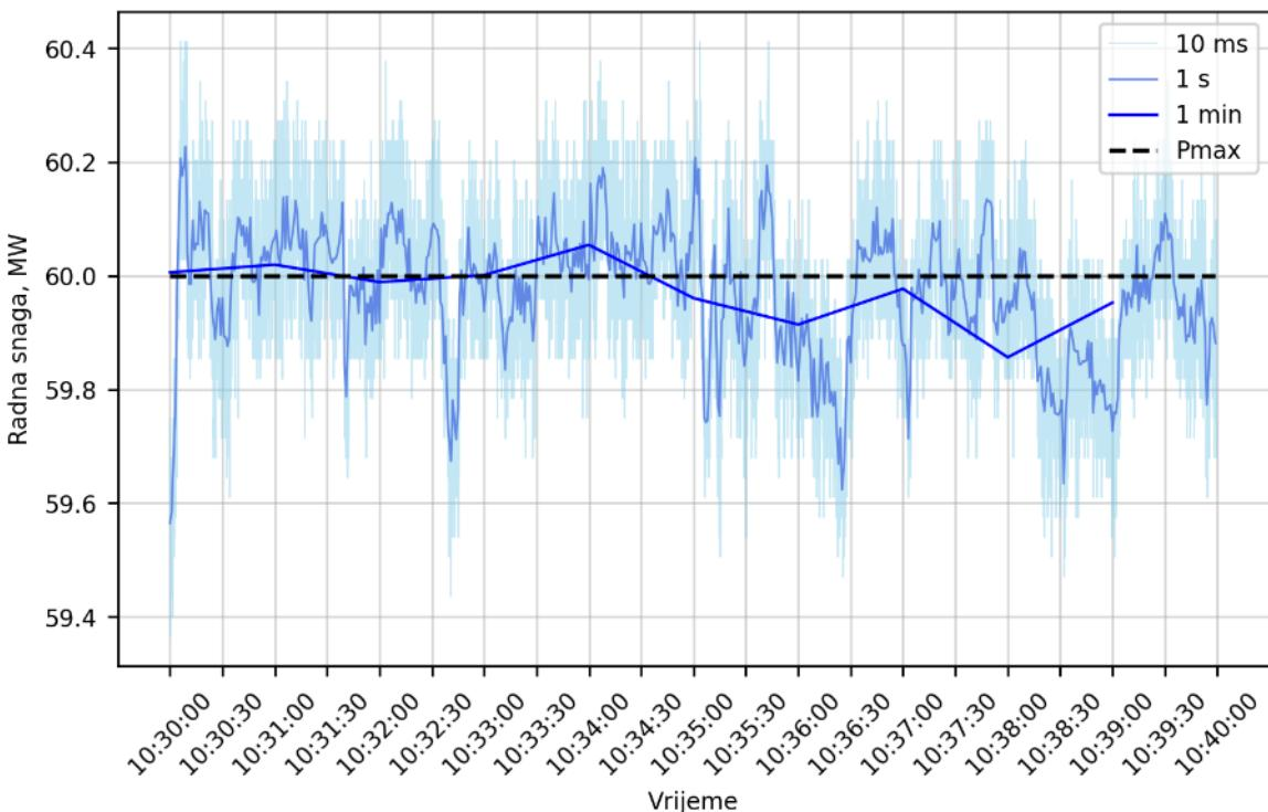
Slika 3-11 Fluktuacije proizvodnje VE oko priključne snage
