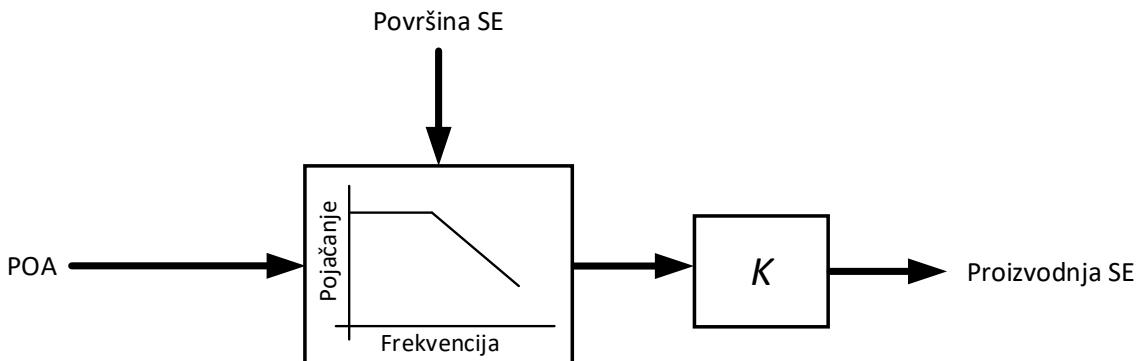
Slika 5-34 Model SE kao niskopropusni filter prvog reda za sunčev zračenje (zasnovano na [48])
