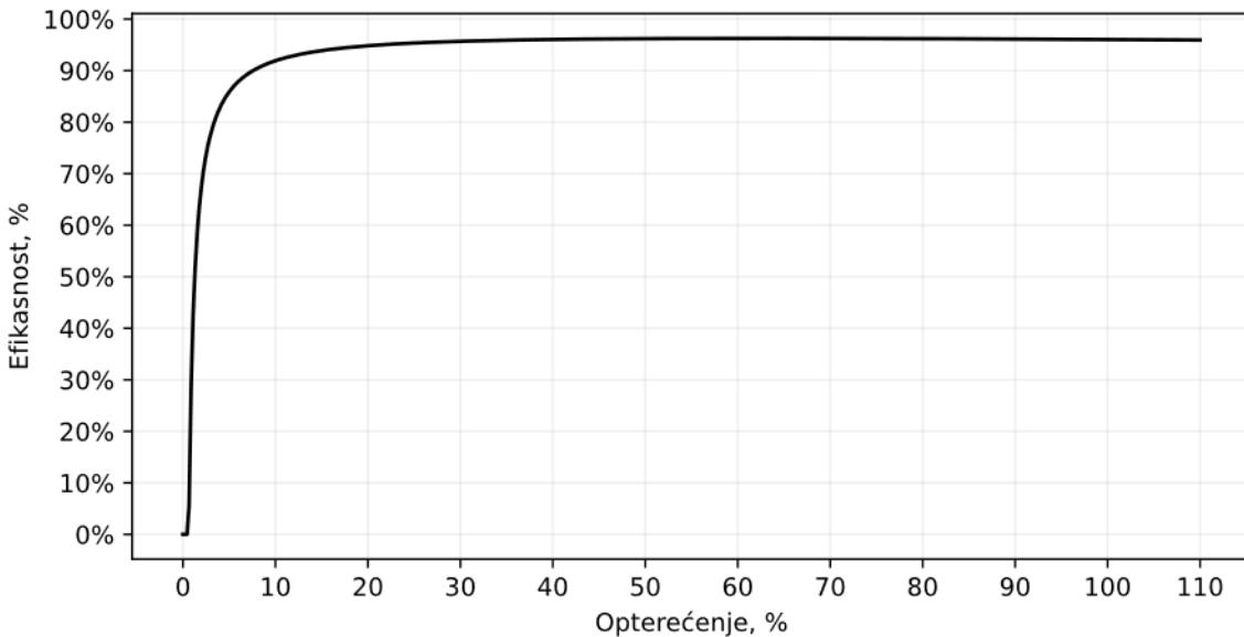
Slika 2-6 Karakteristika efikasnosti izmjenjivača u ovisnosti o opterećenju
