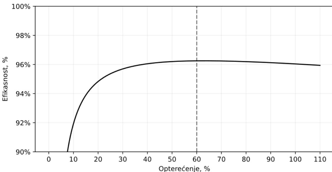
Slika 2-7 Efikasnost izmjenjivača pri rasponu opterećenja  $10\% - 110\%$
