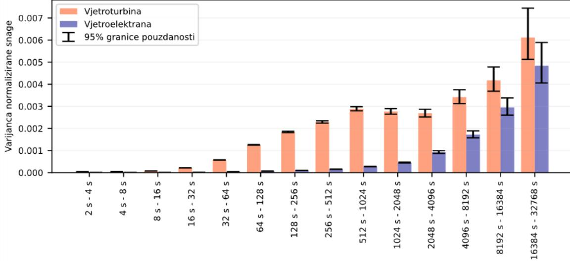
Slika 5-11 Usporedba varijance normaliziranih vremenskih serija izlazne snage vjetroturbine i vjetroelektrane (16 vjetroturbina)
