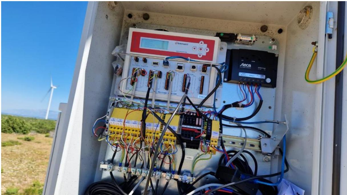
Slika 6-5 Ammonit logger za prikupljanje mjernih podataka
