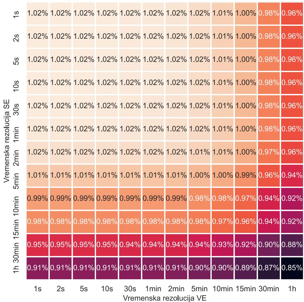
Slika C-1 Odbačena proizvodnja pri različitim vremenskim rezolucijama u hibridnoj elektrani instalirane snage 25,6 MW/25,6 MWp i priključnoj snazi 35,7 MW za period od rujna do studenog
