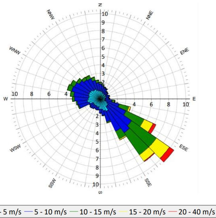
Slika 2-3 Ruža vjetrova na planiranoj lokaciji VE mjerena na anemometru
