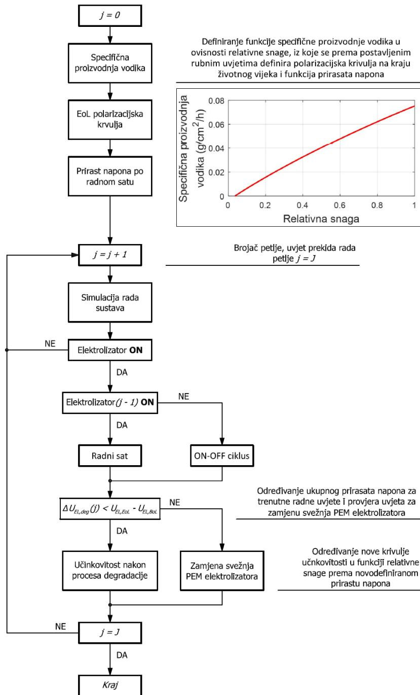
Slika 3.18: Dijagram toka procesa degradacije PEM elektrolizatora
