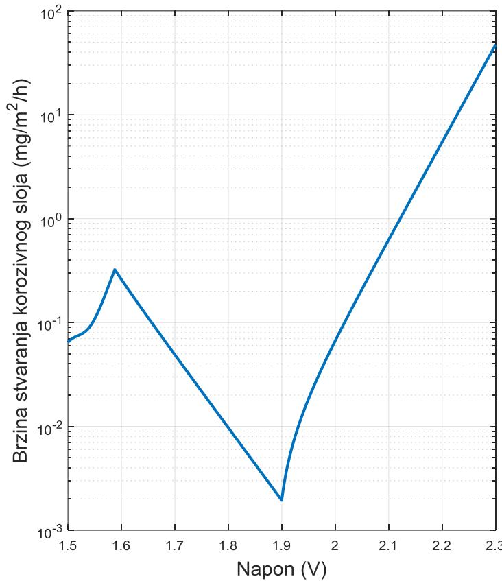
Slika 3.14: Brzina stvaranja korozivnog sloja u funkciji napona
