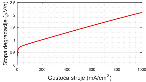
Slika 3.21: Stopa degradacije PEM gorivnog članaka u ovisnosti o gustoći struje
