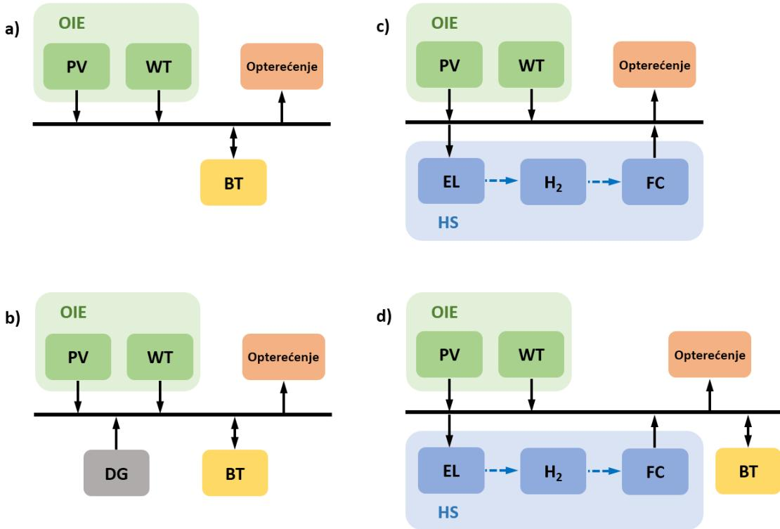
Slika 1.1: Različite konfiguracije samostalnih hibridnih energetskih sustava
