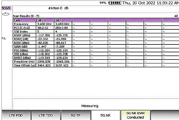
Slika 5.16. Demodulacija signala unutar SSB-a
