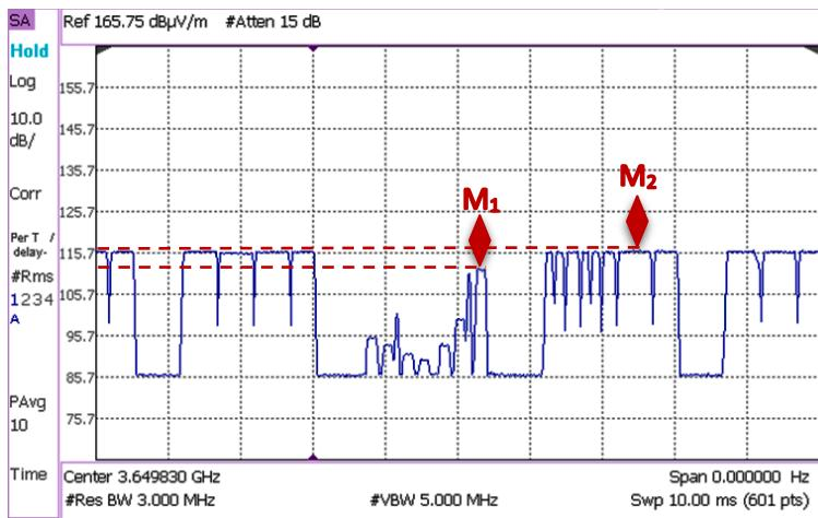
Slika 8.24 Određivanje faktora  $F_{beam}$  mjerjenjem ( $F_{beam} = M_2 - M_1$ )
