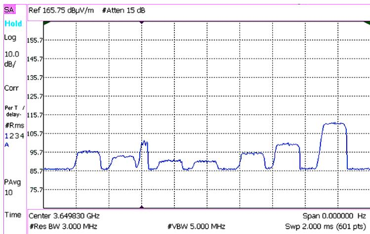
Slika 5.17 Mjerenje snage dominantnog SSB-a u vremenskoj domeni [84]
