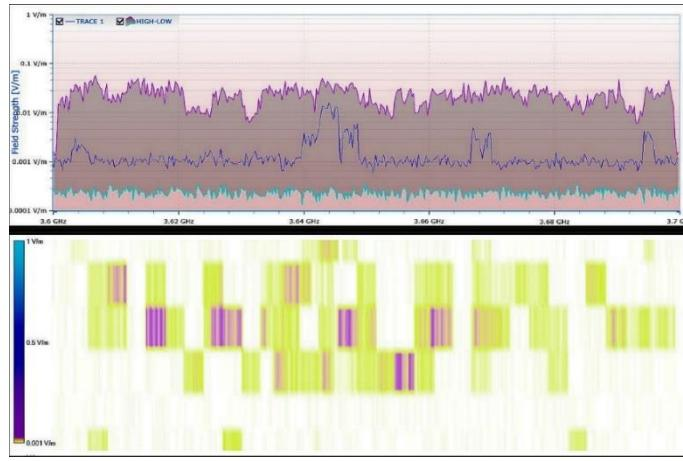
*Slika 5.12 Uskopojasno (kanalno) mjerjenje s centralnom frekvencijom od 3,75 GHz i širinom aktivnog kanala od 100 MHz*
