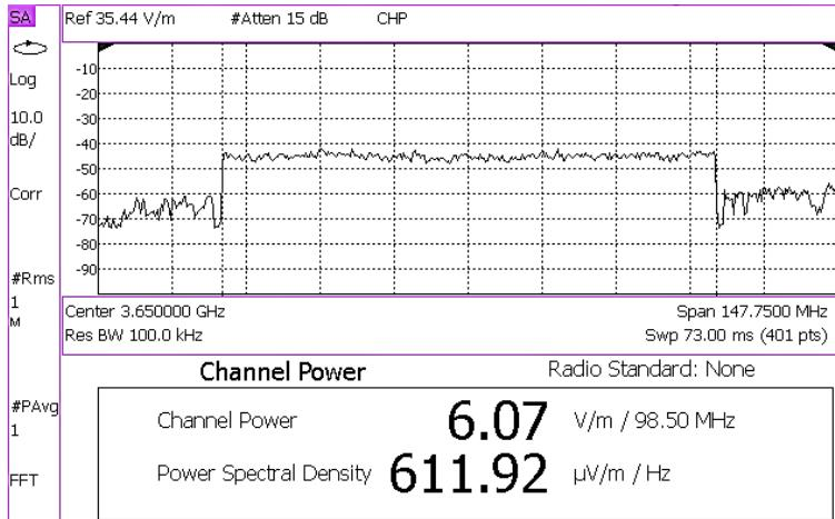
Slika 5.18 Kanalno mjerjenje 5G signala pri uspostavljenom podatkovnom prometu
