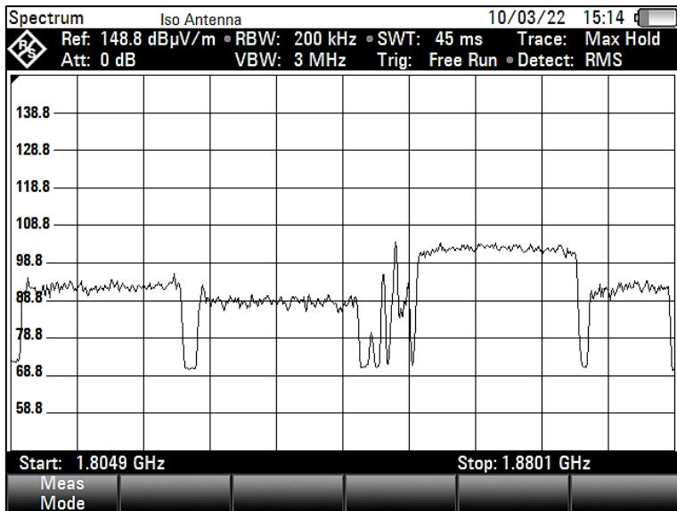
Slika 5.8 Snimka zaslona analizatora spektra pri širokopojasnom mjerenu u frekvencijskoj domeni
