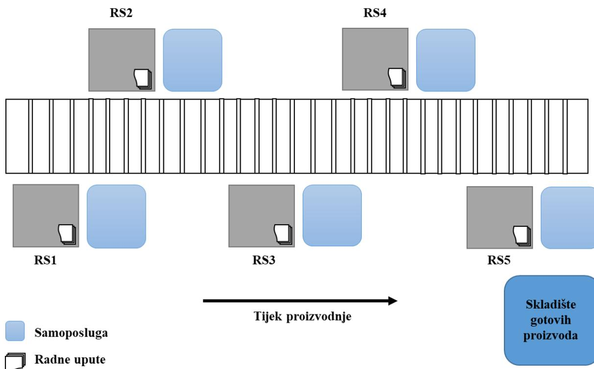
Slika 5.13. Shema montažne linije mjenjačke kutije automobila
