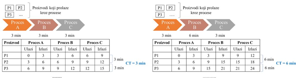
Slika 3.1. Takt proizvodnje na primjeru s tri procesa
