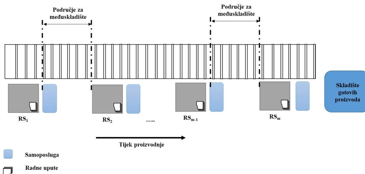
Slika 3.5. Shematski prikaz "I" ručne montažne linije
