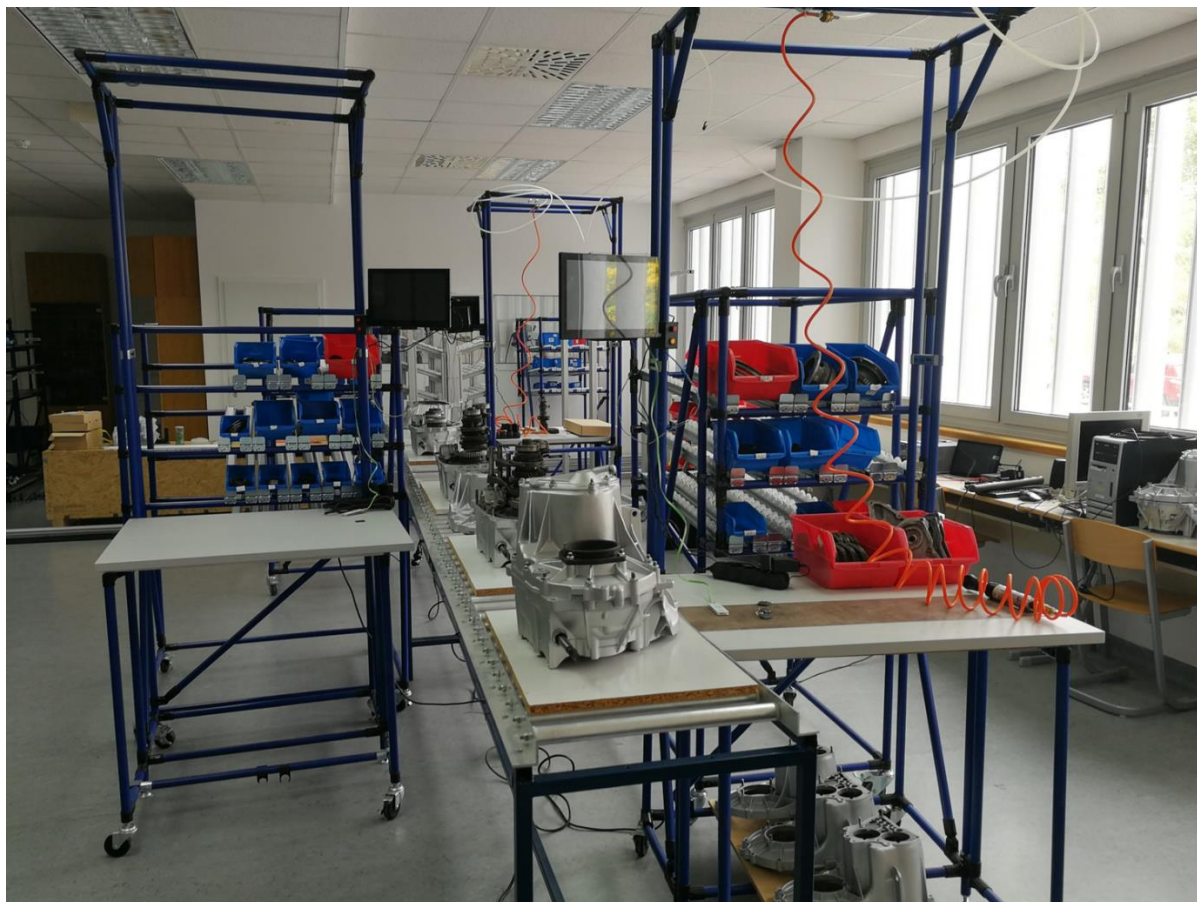
Slika 4.11. Montažna linija mjenjačke kutije automobila
