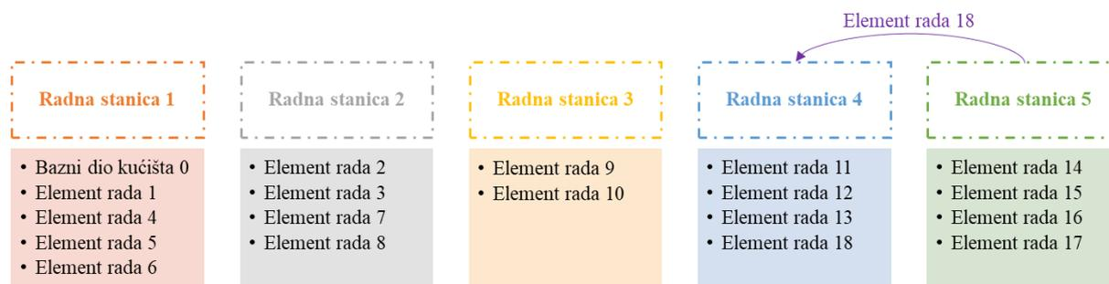
Slika 5.25. Preraspodjela opterećenja nakon ponovnog provođenja LCR simulacije
