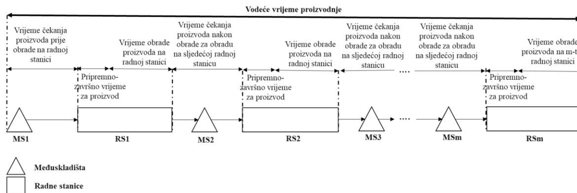
*Slika 3.4. Komponente vodećeg vremena proizvodnje na montažnoj liniji*
