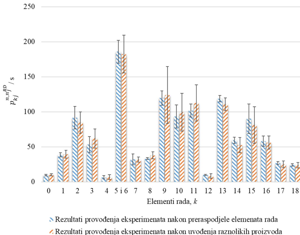
Slika 5.23. Usporedba rezultata prosječnih vremena montaže elemenata rada
