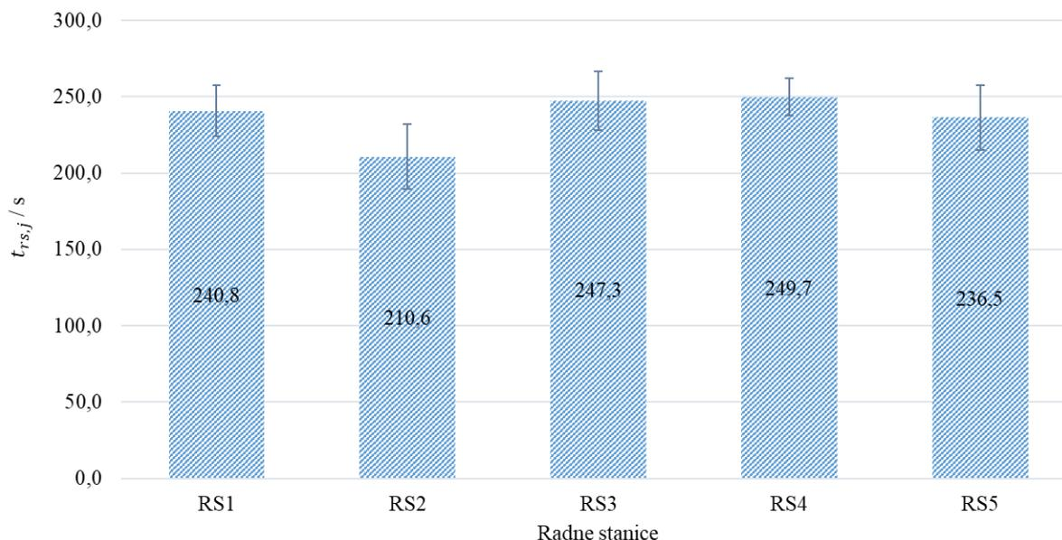
Slika 5.27. Opterećenje radnih stanica nakon podjele elementa rada na manje cjeline koje se montiraju na različitim radnim stanicama
