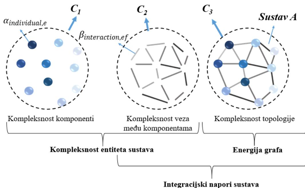
Slika 2.5. Analogija molekularne strukture s proizvodom, [44]
