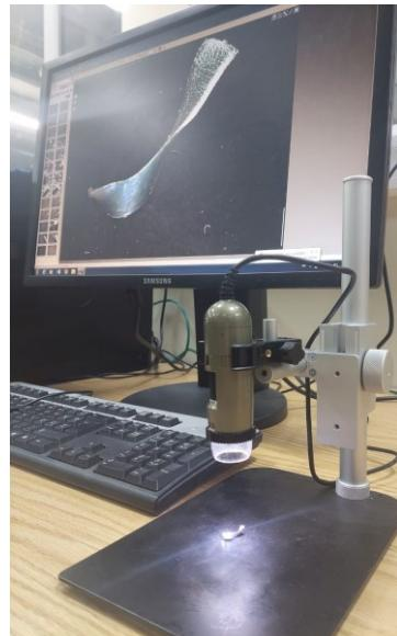
*Slika 5.7. Oprema za mjerjenje geometrije odvojene čestice*
