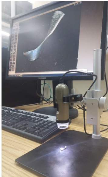
Slika 5.7. Oprema za mjerenje geometrije odvojene čestice
