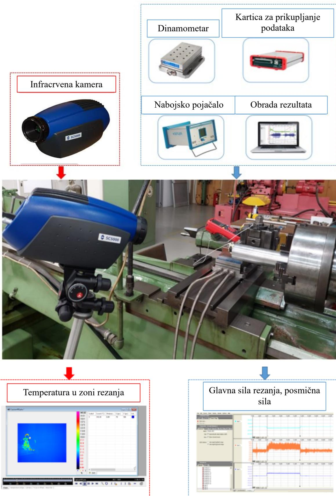
Slika 5.6. Eksperimentalni postav za mjerene komponenti sile rezanja i temperature u zoni rezanja
