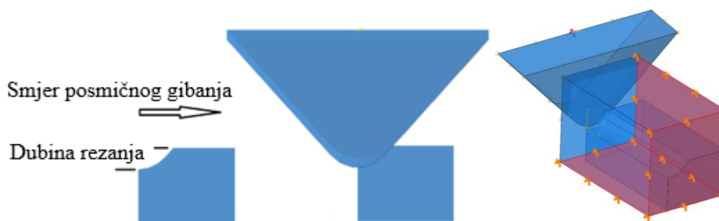
Slika 4.7. Shematski prikaz rezne pločice i obratka [127]
